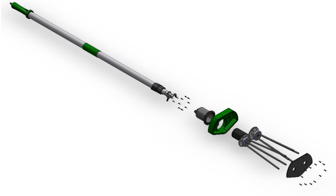
Slika 34. Izometrijski prikaz konačnog koncepta s rastavljenim kućištem
