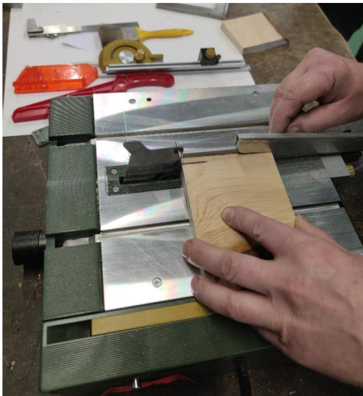
Slika 32. Precizno izrezivanje uzoraka
