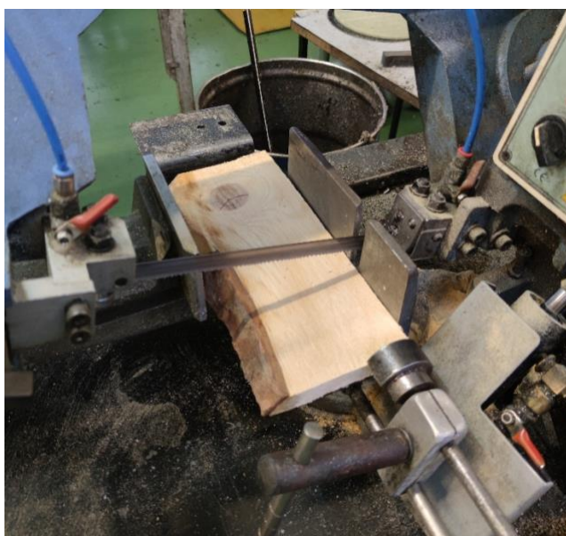
Slika 31. Grubo izrezivanje uzoraka
