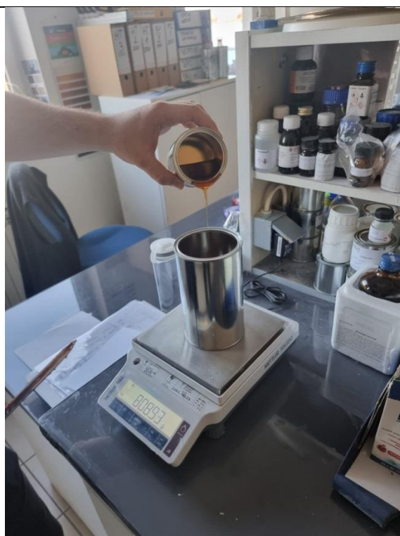
Slika 16. Miješanje komponenti premaza.
