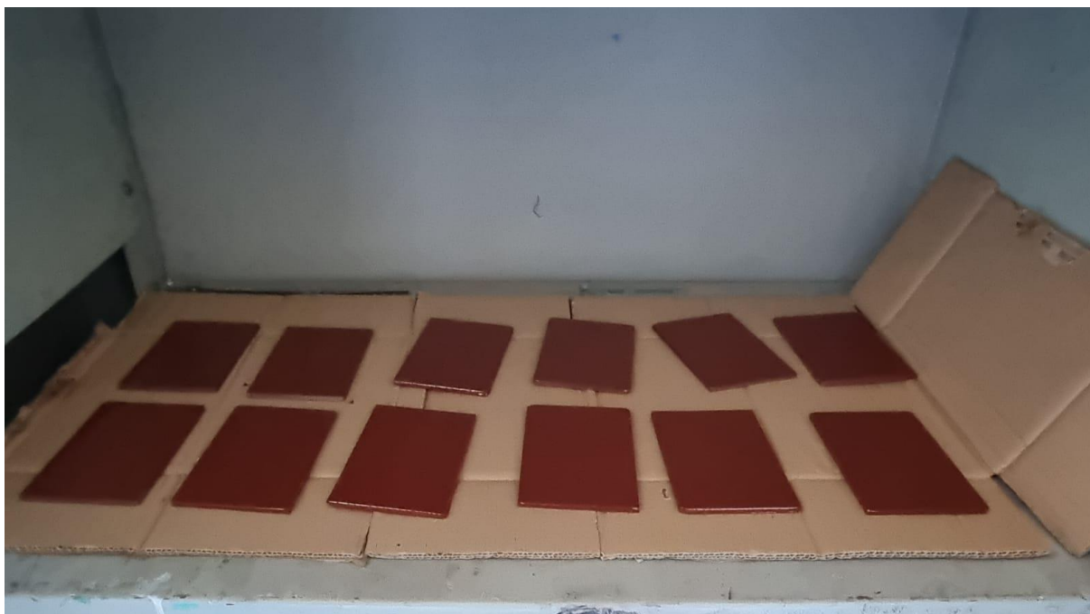
Slika 19. Sušenje uzoraka premazanih temeljnim slojem.
