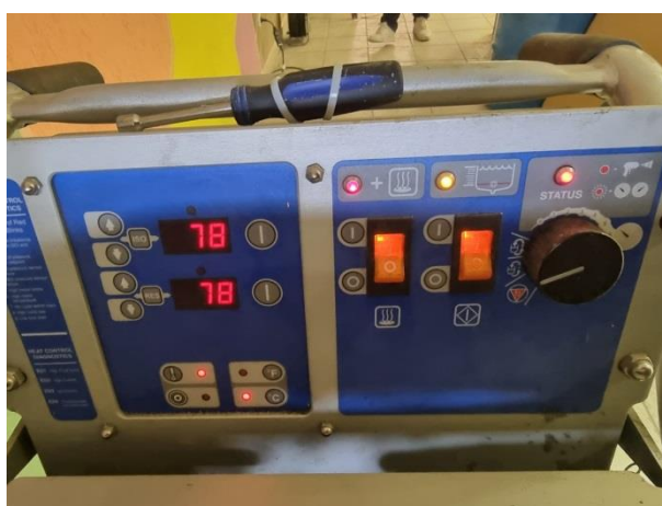
Slika 25. Regulator topline uređaja.
