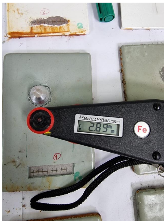
Slika 31. Mjerenje uređajem QNix 1500.
