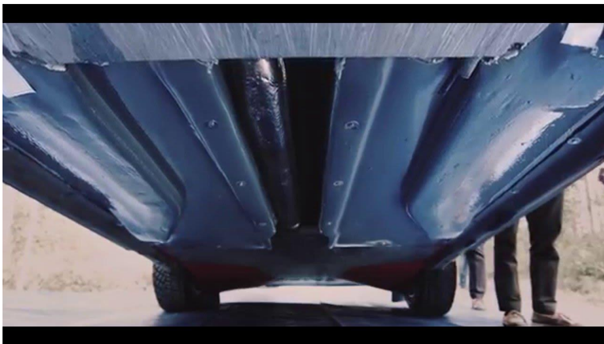
Slika 10. Podvozje automobila zaštićeno poliurea premazom. [25]
