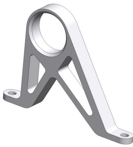
Slika 4.11. Stražnji nosač klackalice u *pullrod* mehanizmu
