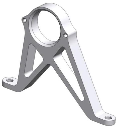
Slika 4.13. Stražnji nosač klackalice u *pushrod* mehanizmu
