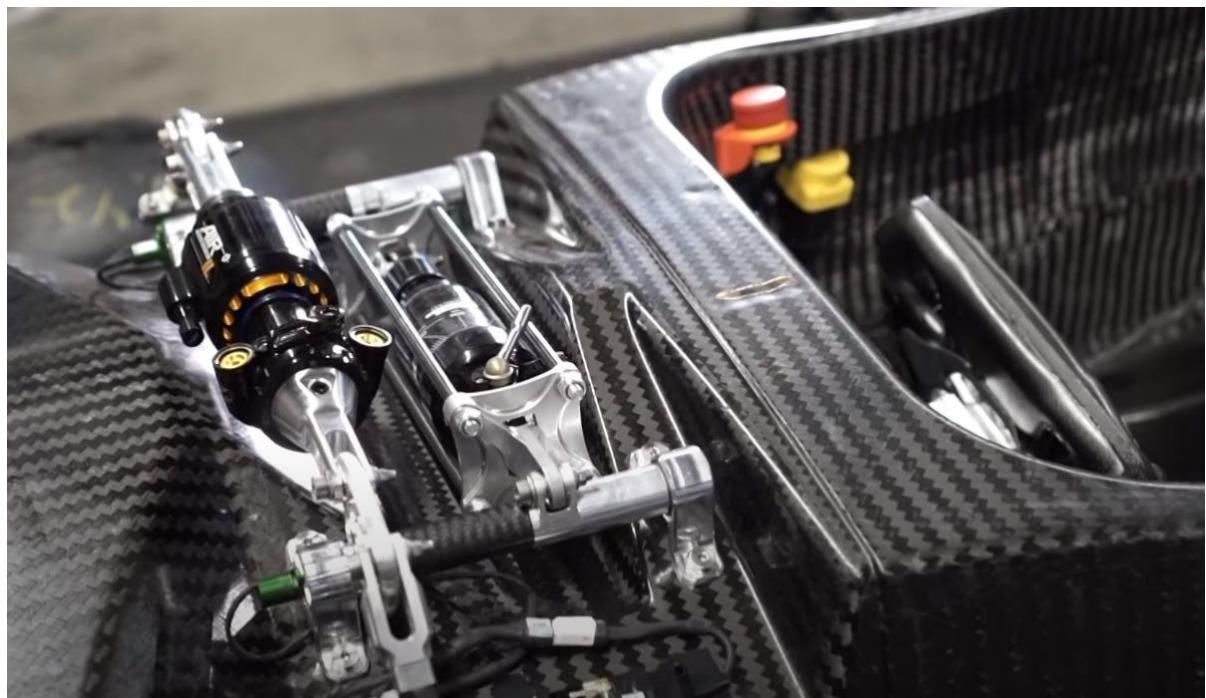
Slika 2.3. Primjer *pushrod* mehanizma 2 [9]
