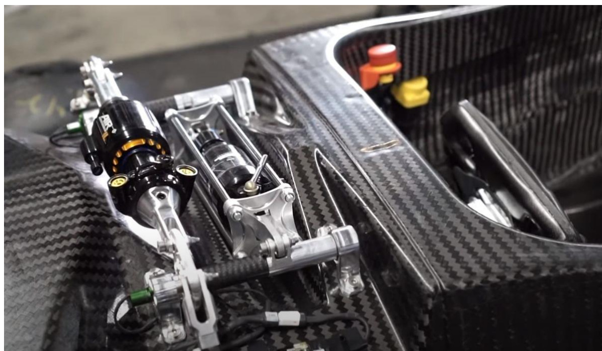
Slika 2.3. Primjer pushrod mehanizma 2 [9]
