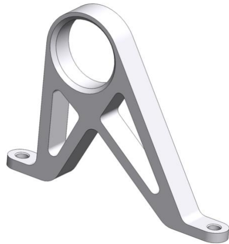
Slika 4.11. Stražnji nosač klackalice u pullrod mehanizmu
