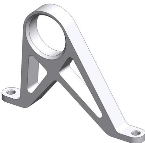
Slika 4.12. Prednji nosač klackalice u *pushrod* mehanizmu
