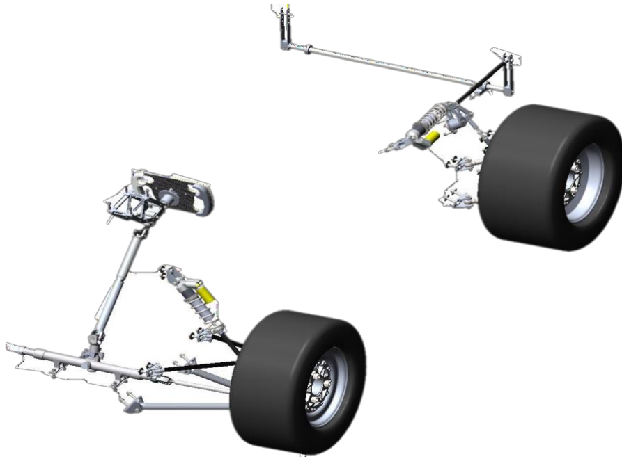
Slika 1.9. Polovični prikaz ovjesa s upravljanjem bolida Vulpes R [1]
