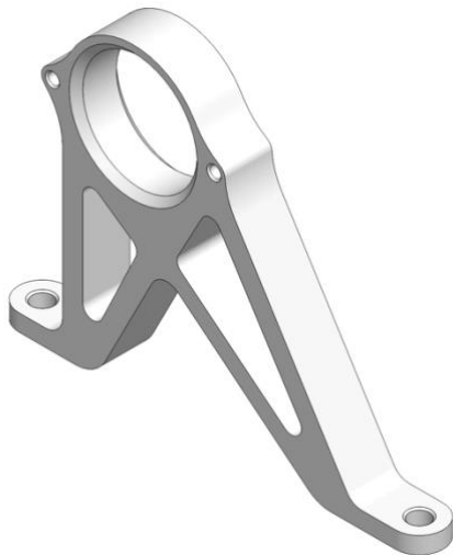
Slika 4.10. Prednji nosač klackalice u pullrod mehanizmu
