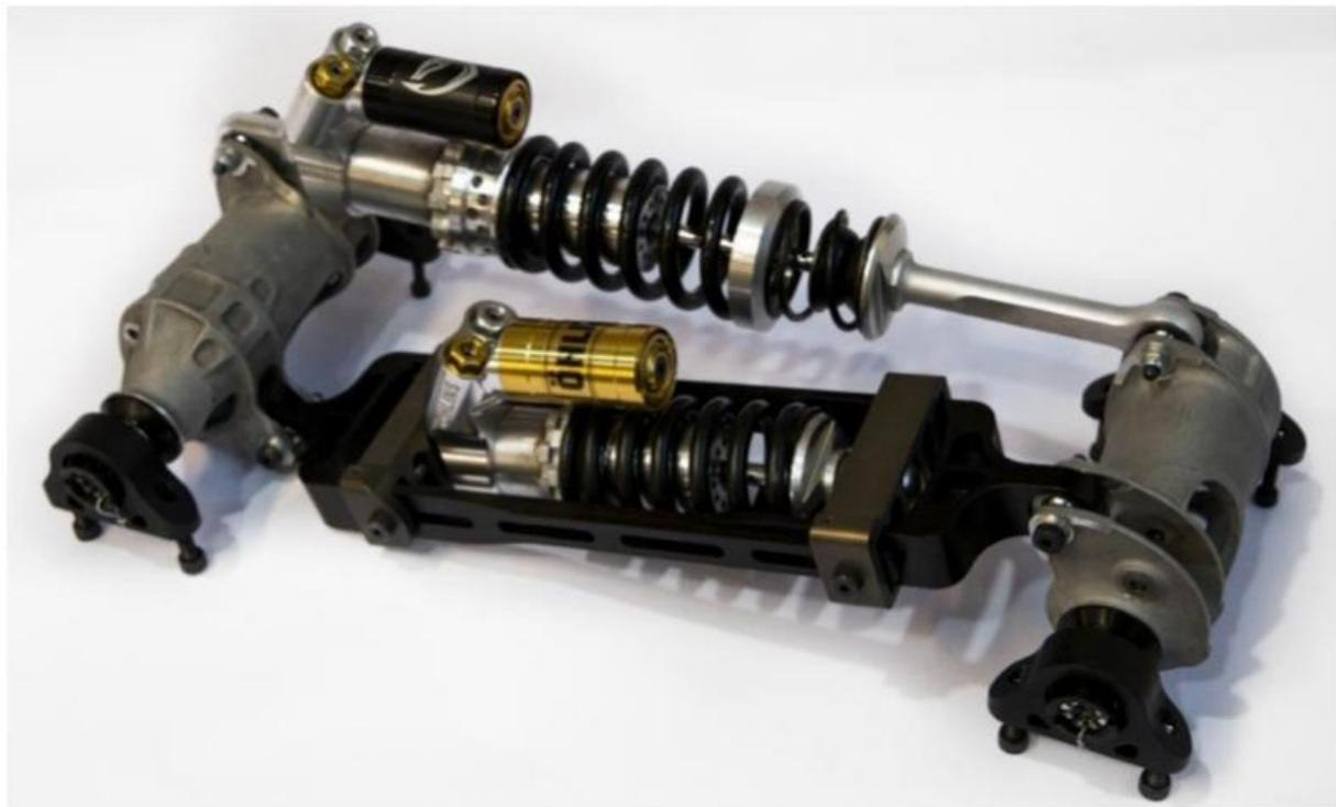
**Slika 3.9. Izvedba kaveznog mehanizma pomoću klizača [13]**
