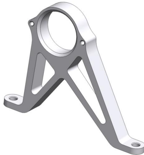
Slika 4.13. Stražnji nosač klackalice u pushrod mehanizmu
