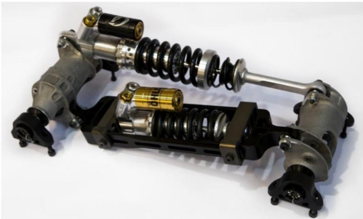
Slika 3.9. Izvedba kaveznog mehanizma pomoću klizača [13]
