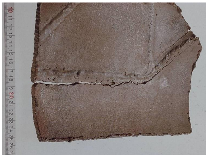
Slika 9. Napetosna korozija u zoni utjecaja topline nastala zavarivanjem [12]
