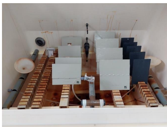
Slika 36. Uzorci postavljeni u komoru (lijevo) i uzorci nakon 48h u komori (desno)
