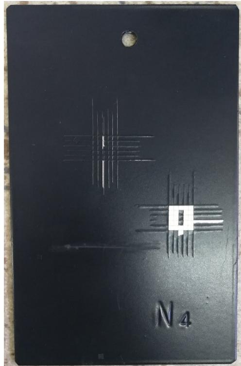
**Slika 45.** Primjer uzorka sa slabom prionljivošću - uzorak N4
