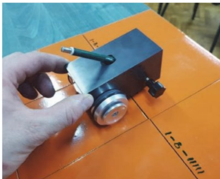
Slika 6. Ispitivanje tvrdoće prevlaka olovkama [12]
