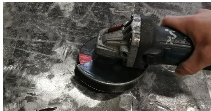
Slika 4. Prikaz čišćenja metala ručnim električnim alatima
