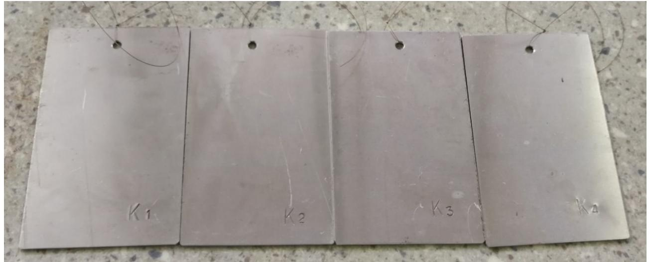
Slika 15. Uzorci obrađeni u kiselini i pasivatoru
