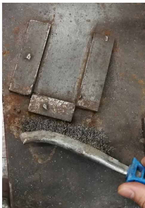
Slika 5. Prikaz ručnog mehaničkog čišćenja metala
