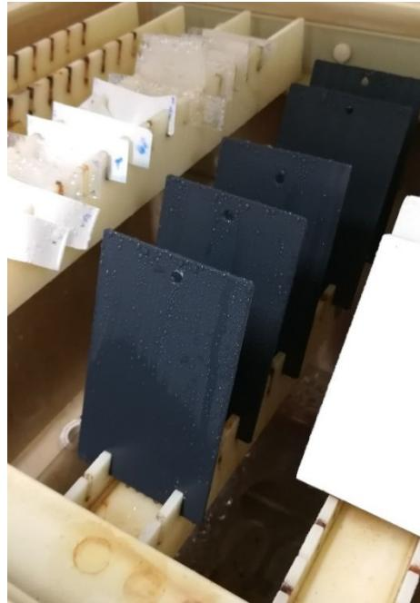
**Slika 39. Uzorci nakon 480h ispitivanja u vlažnoj komori**
