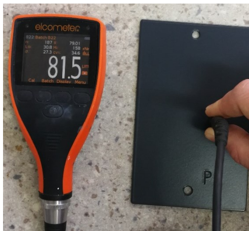
Slika 21. Ispitivanje debljine prevlake
