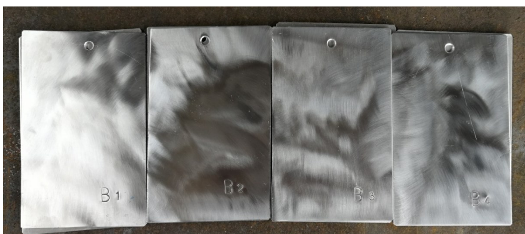
Slika 12. Uzorci nakon obrade električnim ručnim alatom
