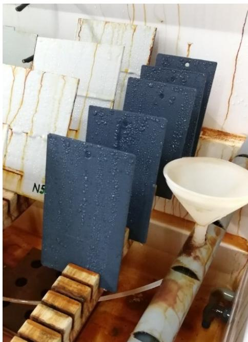
**Slika 42.** Uzorci nakon 480h u slanoj komori
