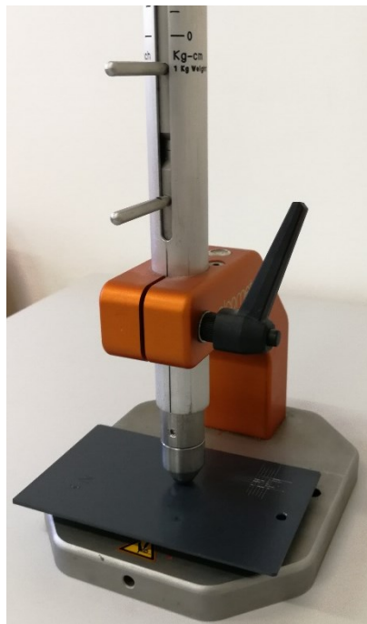
Slika 22. Ispitivanje otpornosti prevlake na udar
