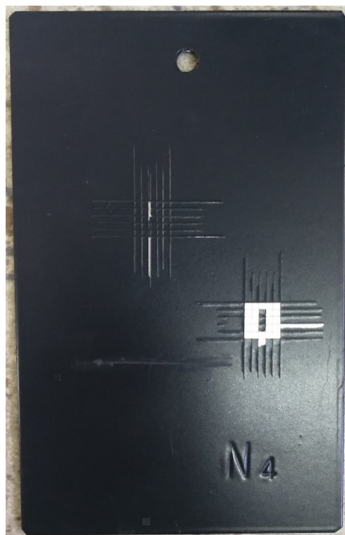
Slika 45. Primjer uzorka sa slabom prionljivošću - uzorak N4
