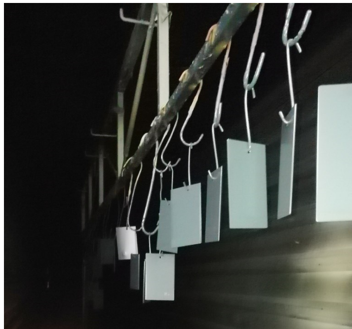
Slika 19. Vađenje uzoraka iz peći
