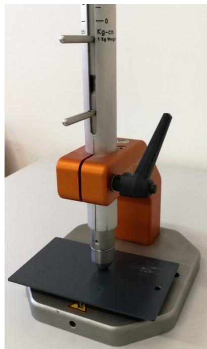
**Slika 22.** Ispitivanje otpornosti prevlake na udar
