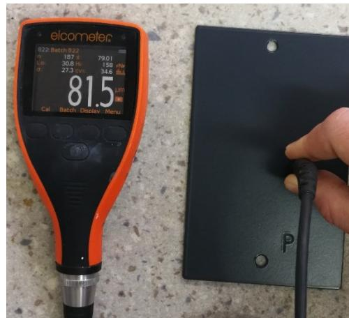
**Slika 21. Ispitivanje debljine prevlake**
