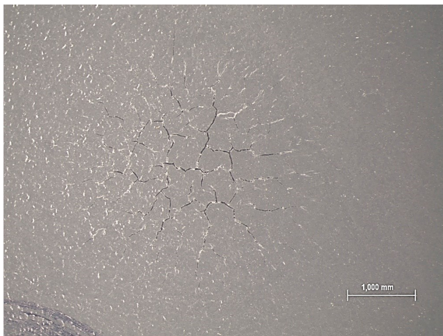
Slika 64. Uzorak K3 - ne zadovoljava; visina s koje je pušten uteg pri kojoj prevlaka nije zadržala svoja svojstva kao ni mikro i makro konzistentnost iznosi 5 cm
