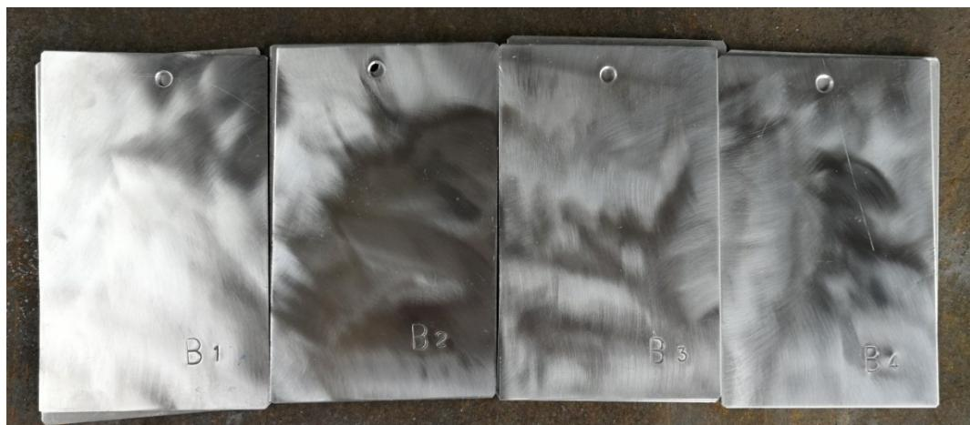
Slika 12. Uzorci nakon obrade električnim ručnim alatom
