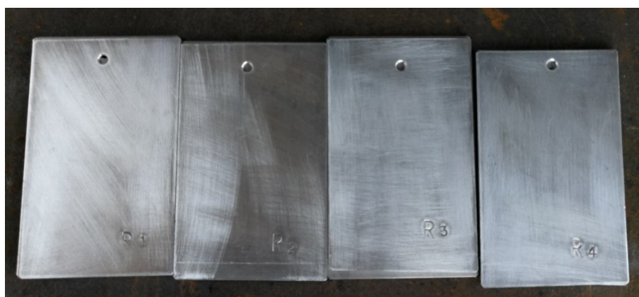
Slika 10. Uzorci pripremljeni ručno brusnim papirom
