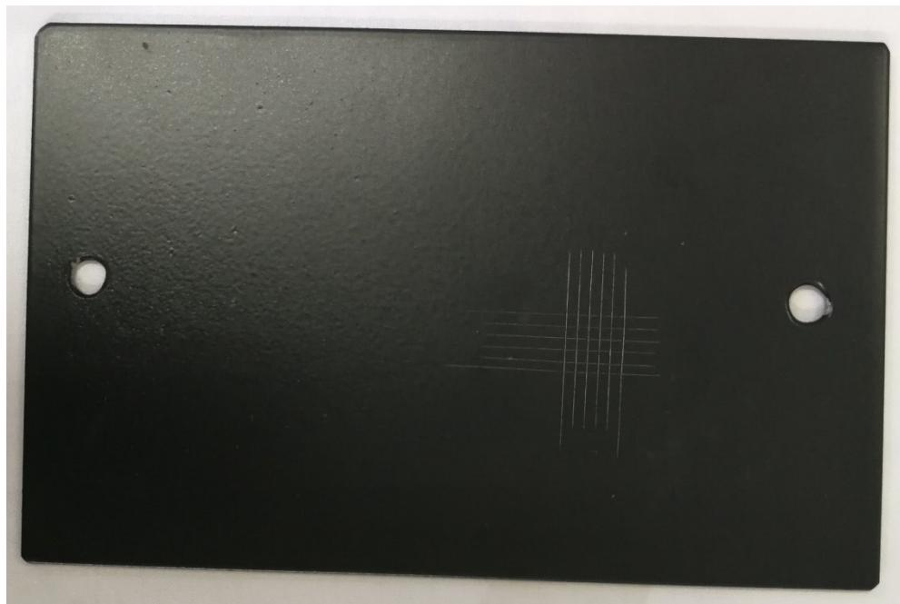
**Slika 36. Očitavanje rezultata ispitivanja**
