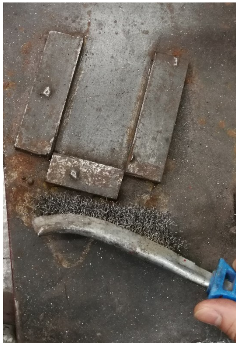
Slika 5. Prikaz ručnog mehaničkog čišćenja metala
