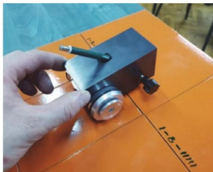
Slika 6. Ispitivanje tvrdoće prevlaka olovkama [12]
