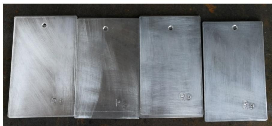
Slika 10. Uzorci pripremljeni ručno brusnim papirom
