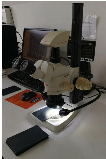
**Slika 23.** Prikaz stereomikroskopa LEICA MZ6
