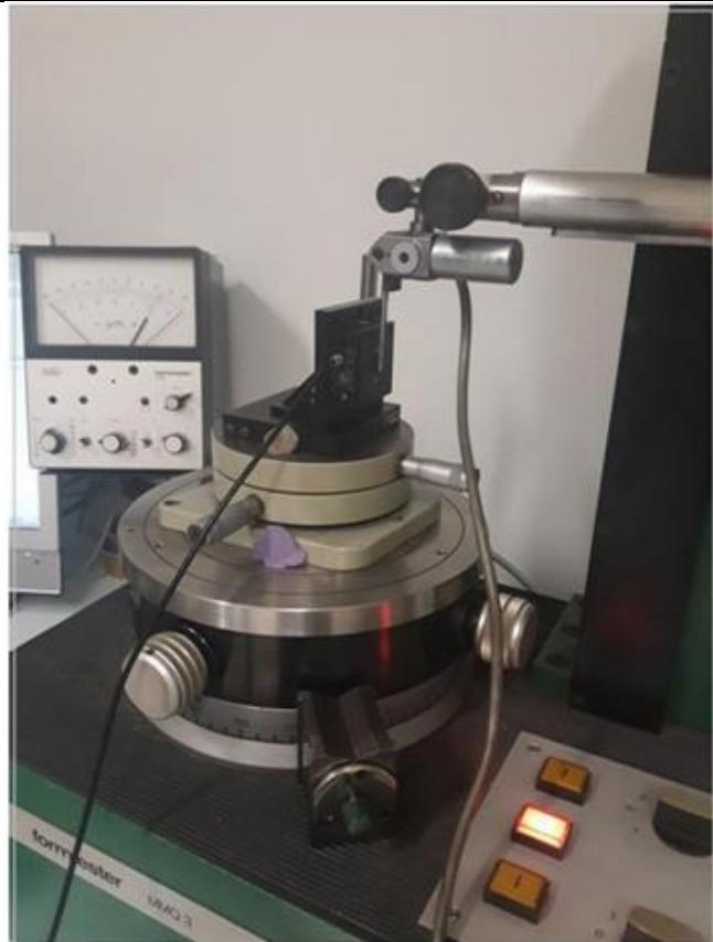
**Slika 16. Umjeravanje uređaja za ispitivanje kružnosti piezoelementom [5]**
