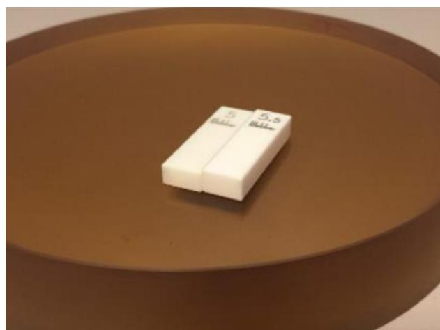
Slika 5. Mjerne pločice na rotirajućem stolu [7]
