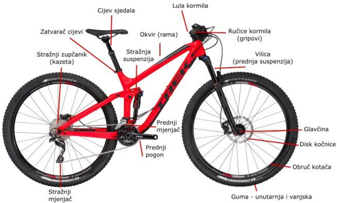
**Slika 1 Dijelovi bicikla**
