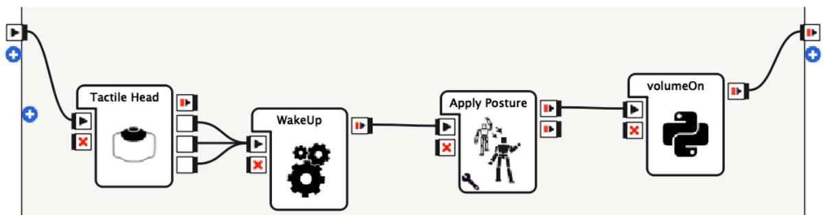
**Slika 38. Dijagram blok za ponovno pokretanje robota**
