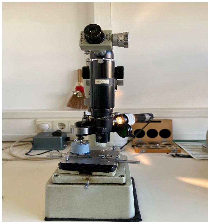
Slika 41. Mikrotvrdomjer PMT-3
