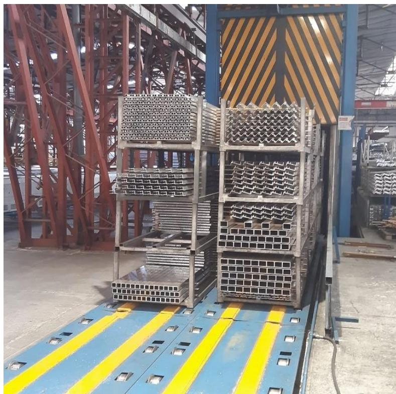
**Slika 22. Profili u korpama za dozrijevanje ispred peći**
