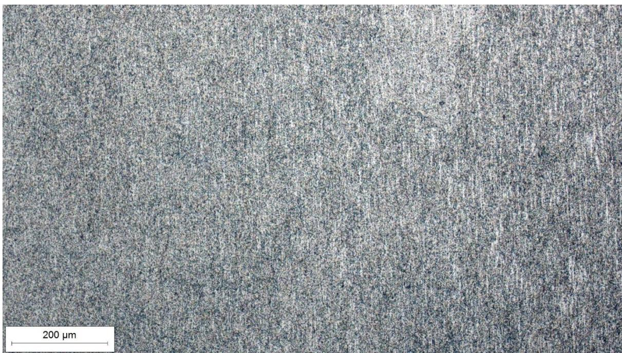
Slika 38. Mikrostruktura legure 6060 snimljena pri povećanju 100× u nagriženom stanju
