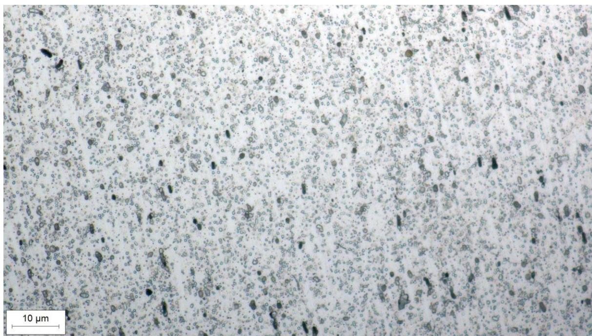
Slika 36. Mikrostruktura legure 6063 snimljena pri povećanju  $500\times$  u nagriženom stanju
