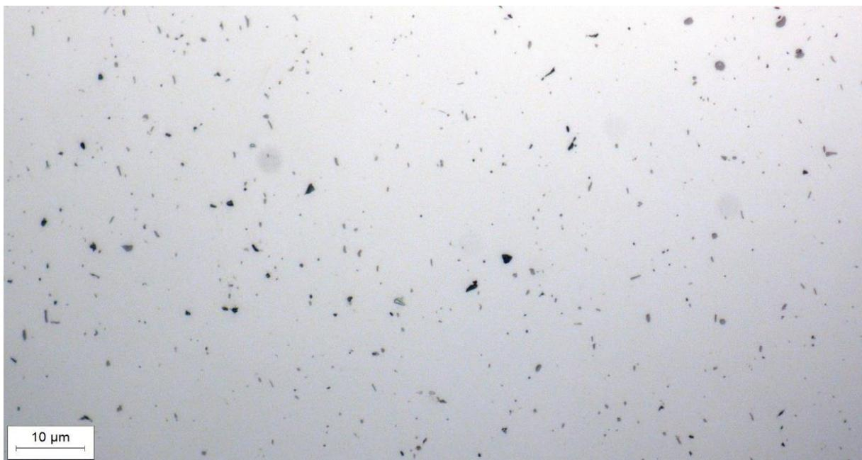
Slika 31.. Mikrostruktura legure 6082 snimljena pri povećanju  $500\times$  u poliranom stanju
