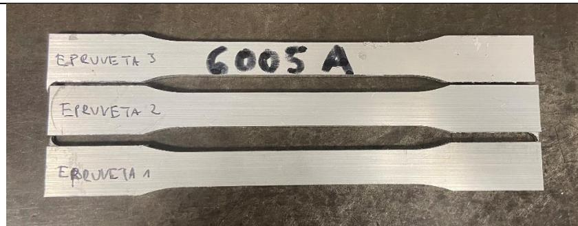
Slika 45. Ispitni uzorci legure 6005A
