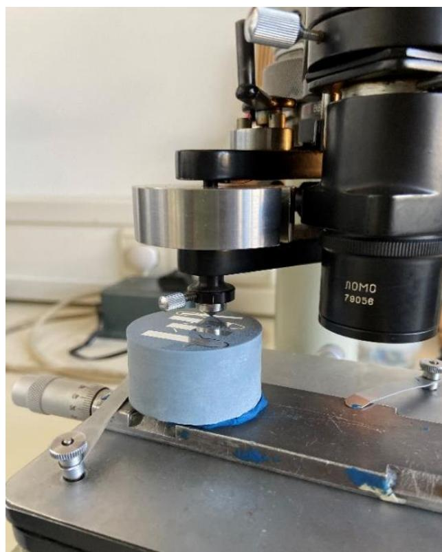
**Slika 42. Mjerenje mikrotvrdoće po Vickersu HV0,2**
