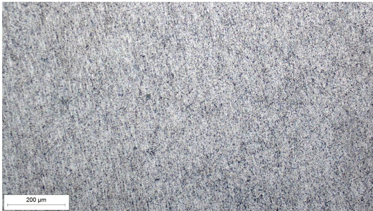
Slika 35. Mikrostruktura legure 6063 snimljena pri povećanju  $100\times$  u nagriženom stanju
