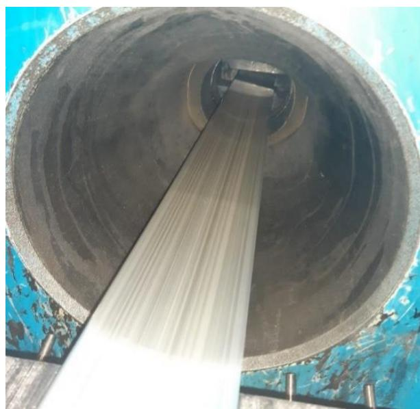
**Slika 20. Konačni oblik profila na izlazu alata**
