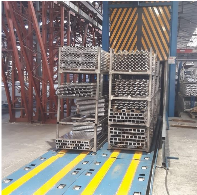
Slika 22. Profili u korpama za dozrijevanje ispred peći
