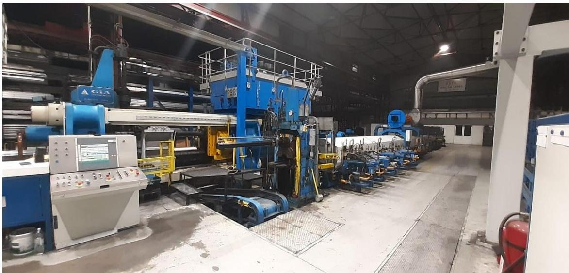
**Slika 15. Horizontalna hidraulička preša**
