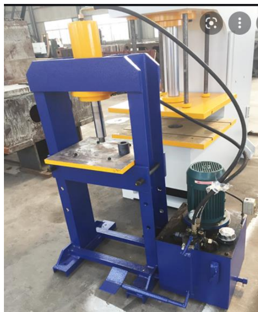
Slika 4. Hidraulična preša s stupovima od „U“ profila
