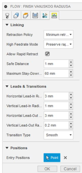
Slika 58 „Fina obrada vanjskog zaobljenja“: Povezivanje (*Linking*)
