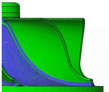
Slika 72 Usporedni prikaz lopatice obratka nakon operacije „Fina obrada unutarnjeg dijela obruba“
