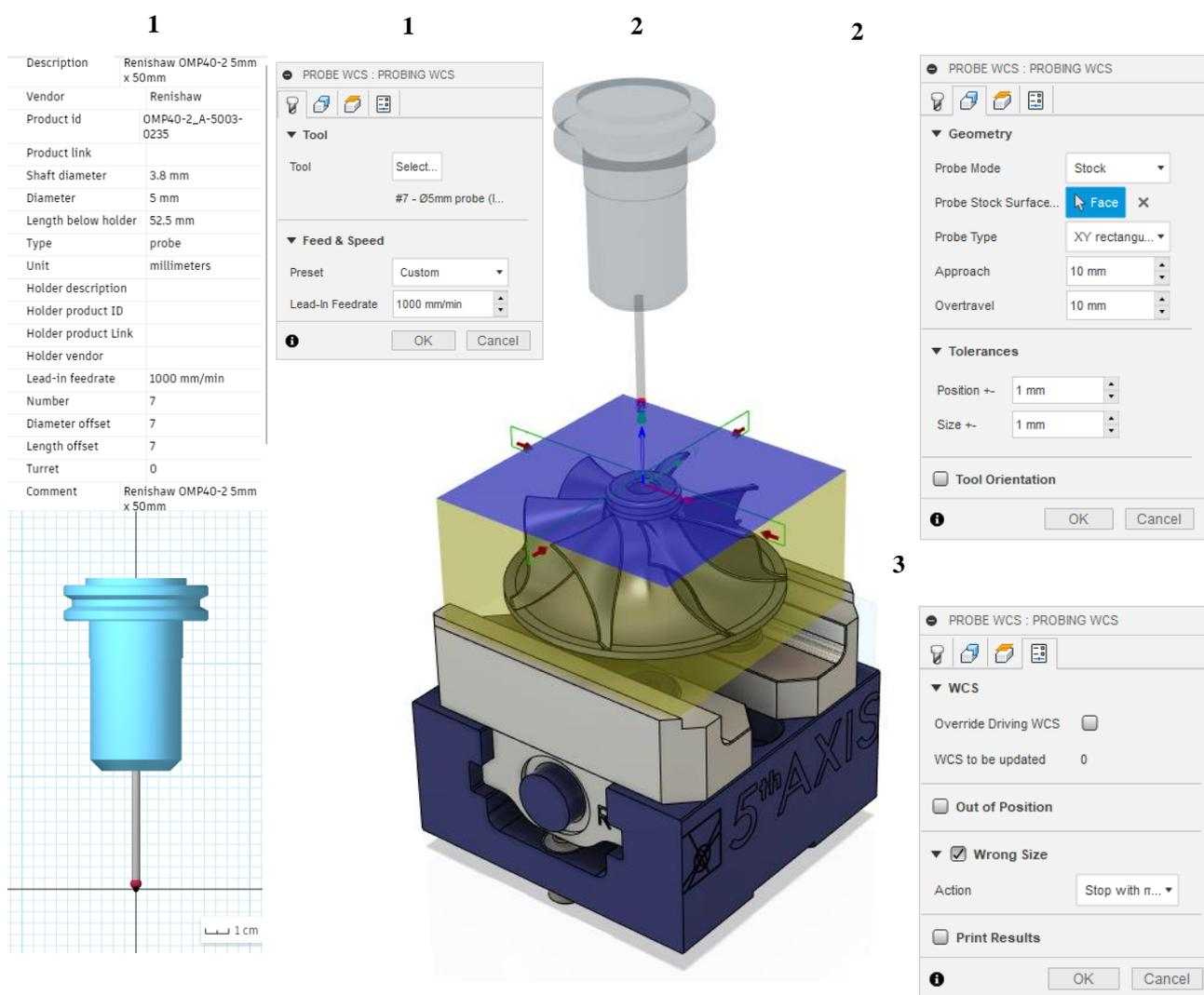
Slika 15 Umjeravanje nul točke obratka: alat (1); geometrija (2); akcija (3)
