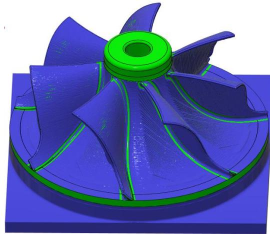
Slika 64 Usporedni prikaz obratka nakon operacija „Pencil obrada“
