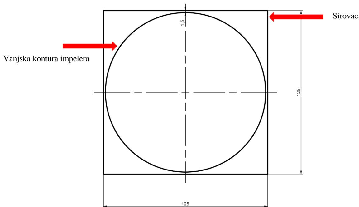
Slika 11 Poprečni presjek sirovca i kontura impelera
