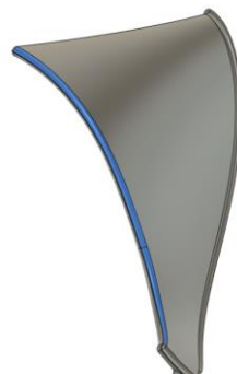
Slika 73 Odabrana površina u operaciji Fina obrada vanjskog dijela obruba
