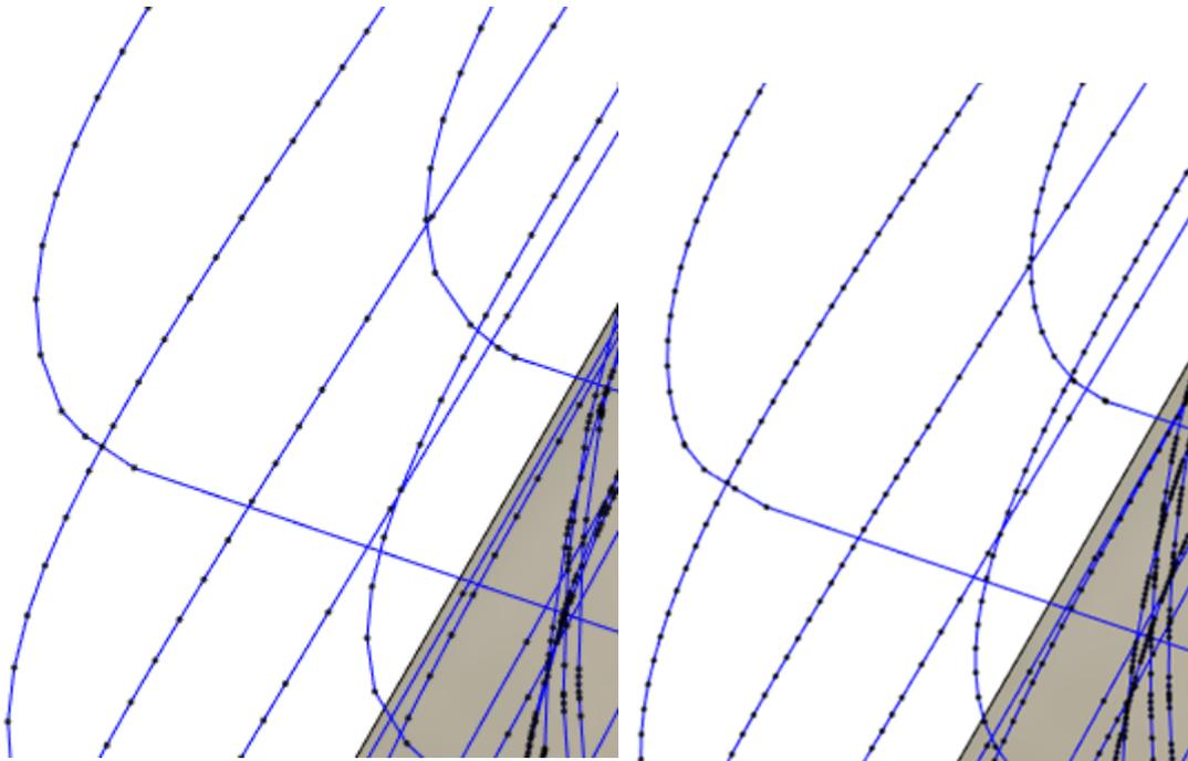
**Slika 22 Opća tolerancija 0,1 mm (lijevo); 0,025 mm (desno)**
