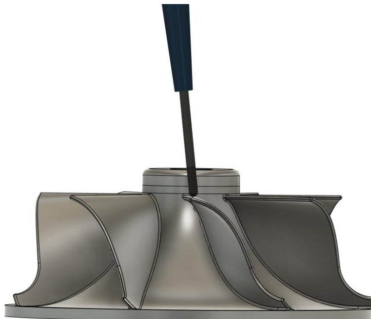
Slika 68 Prikaz nagiba alata u operaciji „Fina obrada prijelaza“
