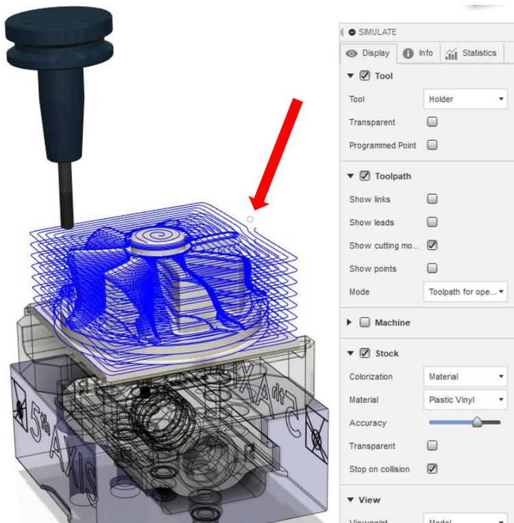
Slika 24 Točka ulaza reznog alata u zahvat
