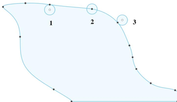
Slika 30 Načini zadržavanja alata na primjeru zone obrade za grubu obradu džepova:
