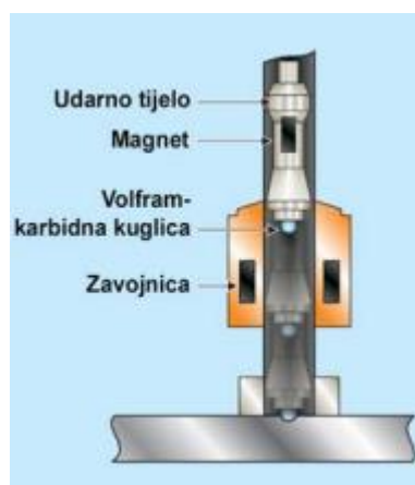
Slika 6. Dijelovi udarnog tijeka kod TIV metode [4]
