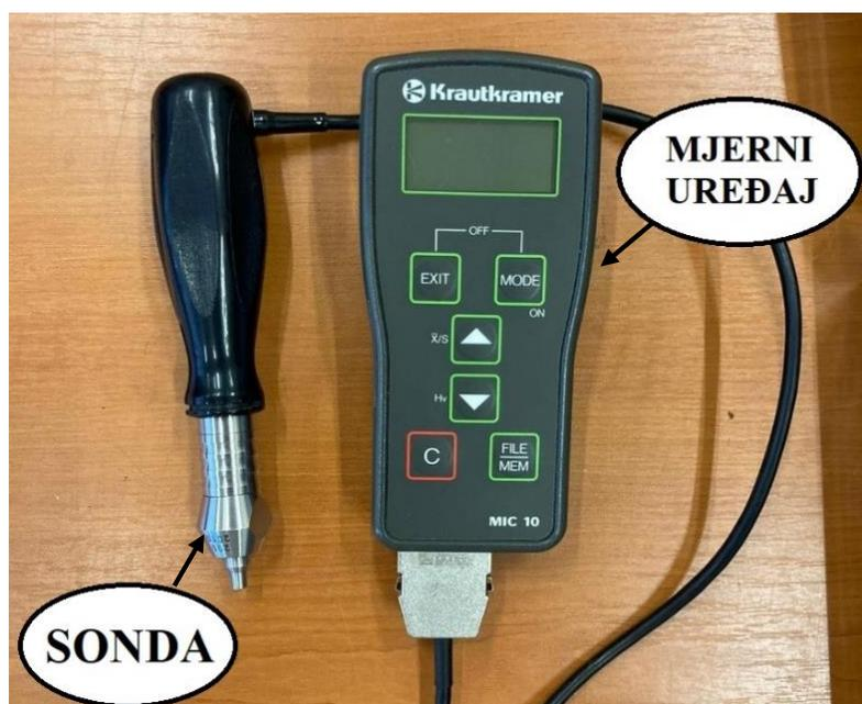
Slika 14. UCI uređaj i sonda [9]
