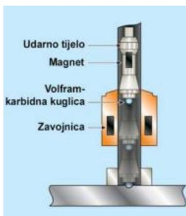
Slika 6. Dijelovi udarnog tijeka kod TIV metode [4]
