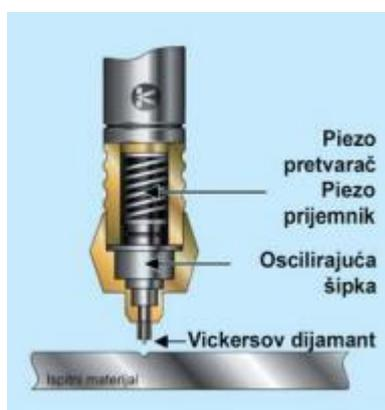
Slika 4. Sonda UCI prijenosnog tvrdomjera [4]
