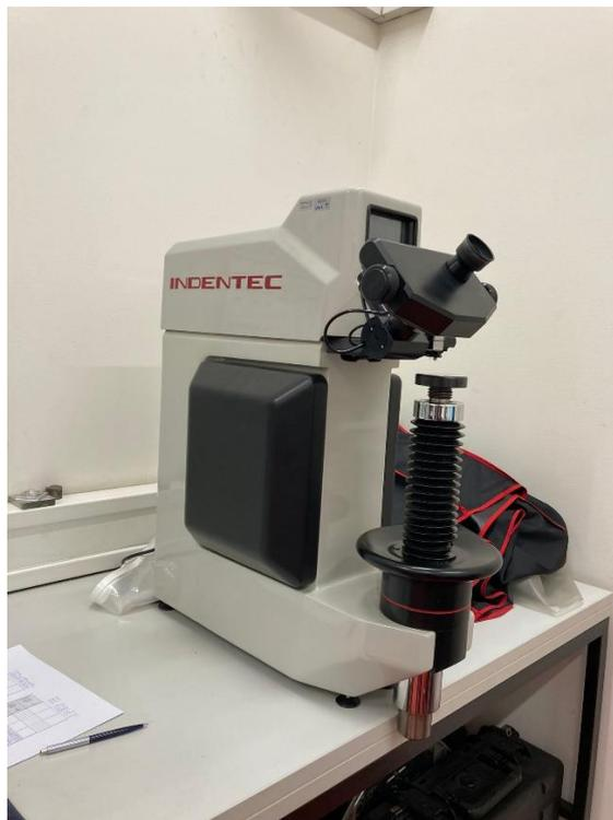
Slika 19. Vickers-ov stabilni uređaj [9]
