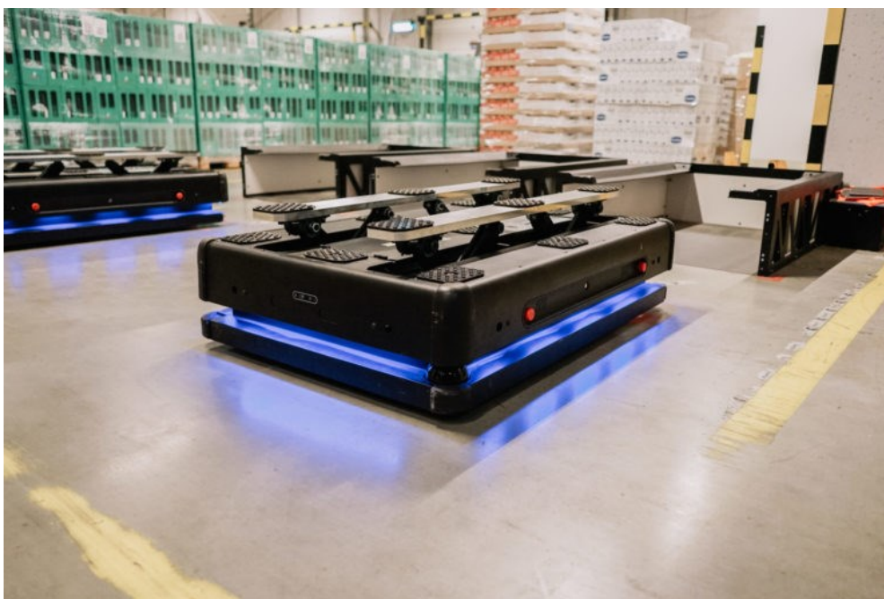
Slika 33. Primjer AMR vozila kompanije Gideon Brothers [22]
