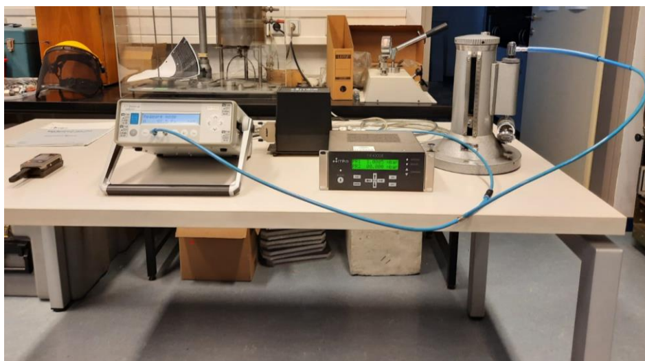
Slika 21. Postavljeni instrumenti za provebu umjeravanja od 0 do 100 Pa
