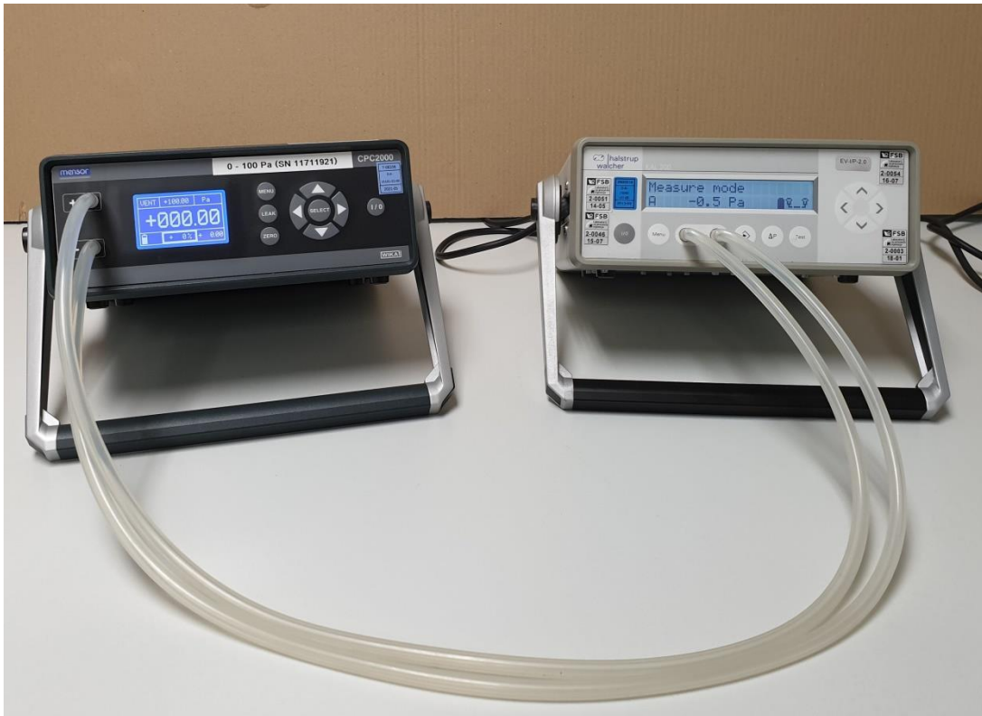
Slika 17. Mensor, model CPC2000 (lijevo) s Halstrup Walcher, model KAL 200 (desno)
