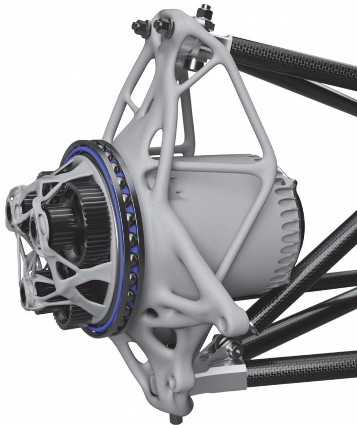
Slika 18. Topološki optimirana glavčina kotača FS bolida [17]
