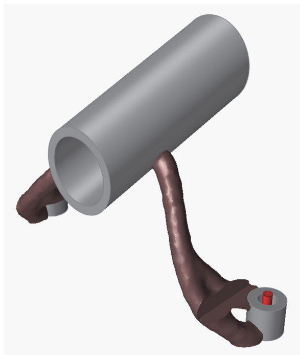
Slika 55. Pogled broj 2 na topološki optimiranu konstrukciju s minimiranom masom
