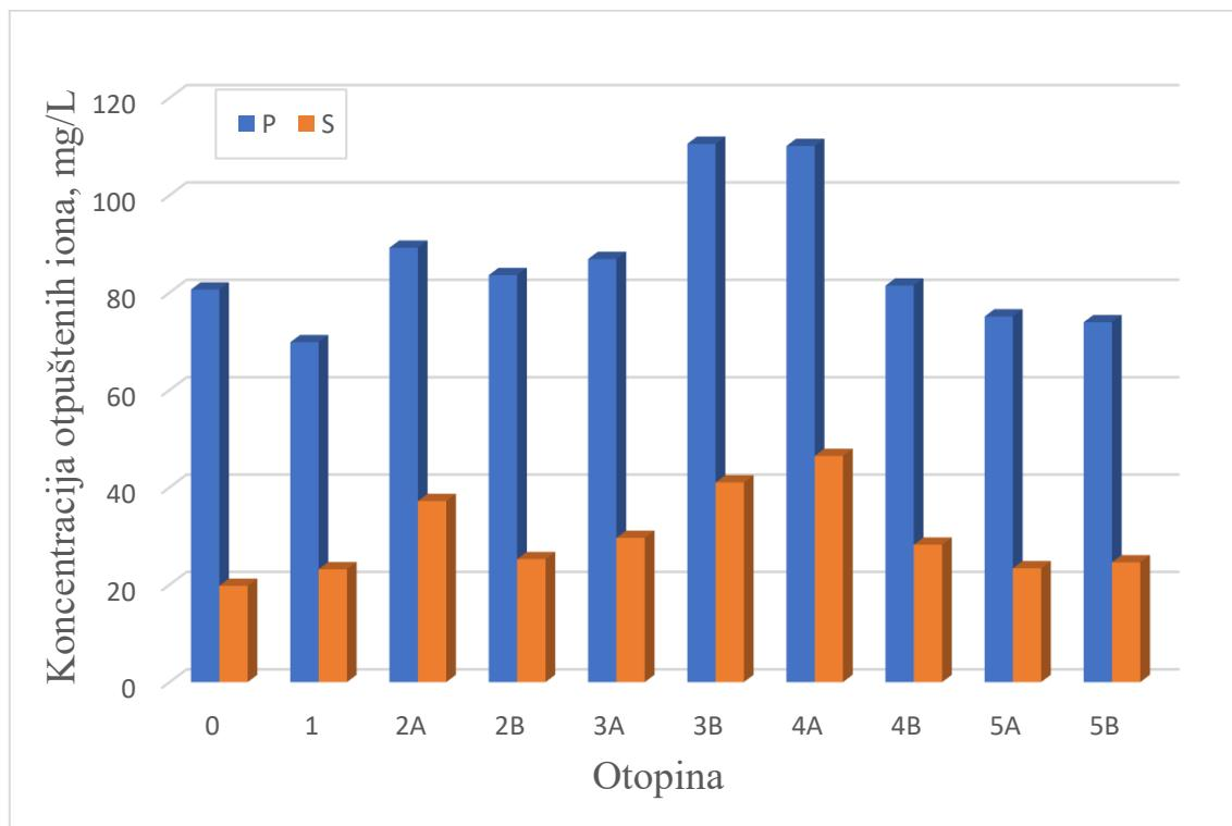
**Slika 42. Koncentracija otpuštenih iona fosfora i sumpora nakon 44 dana izlaganja uzorka u otopini**
