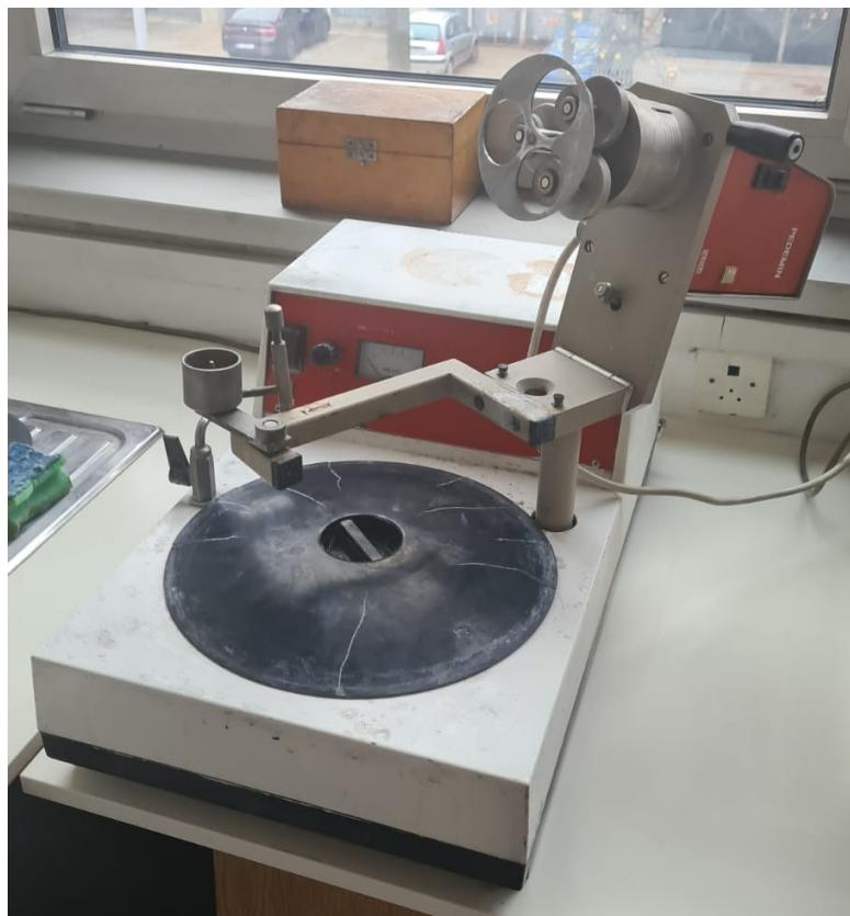
**Slika 19.** Uredaj za poliranje uzorka Struers DAP-V
