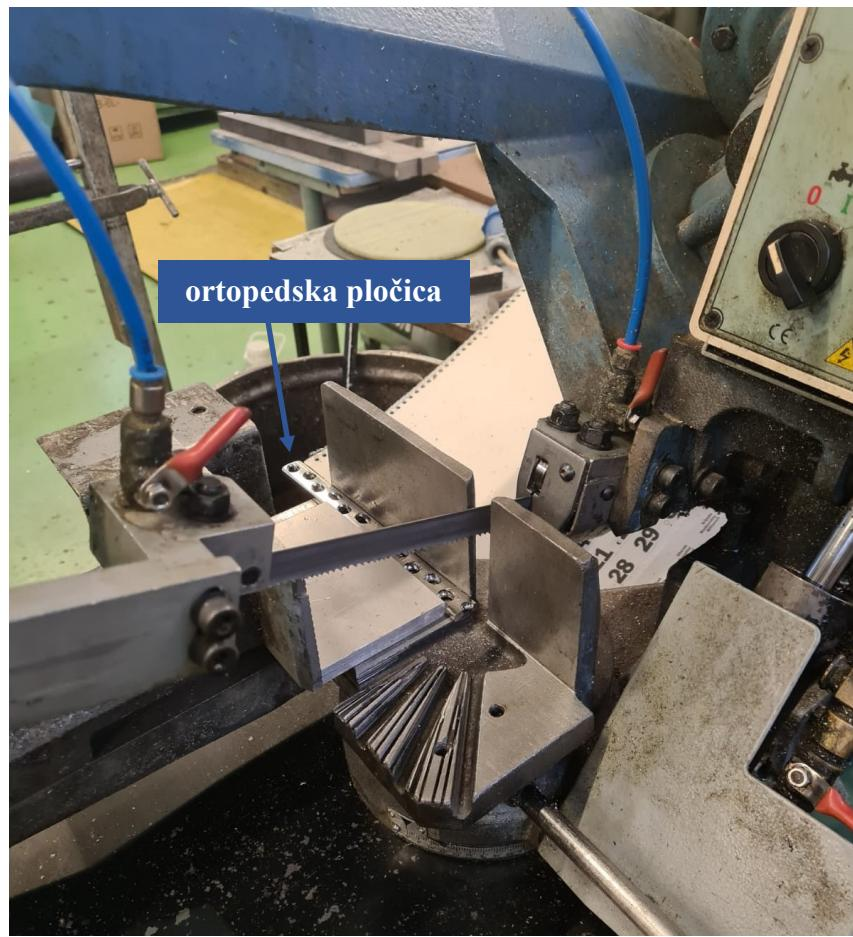
**Slika 15.** Izrezivanje uzoraka na tračnoj pili
