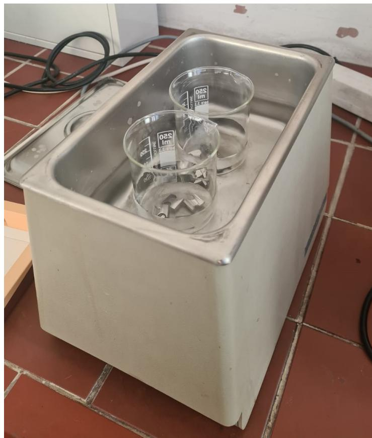
Slika 30. Čišćenje uzorka u ultrazvučnoj kupelji
