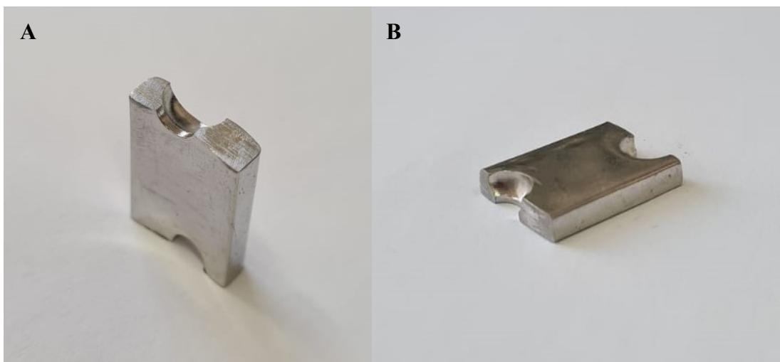
**Slika 16.** Uzorak izrezan iz ortopedске pločice prije (A) i nakon (B) prešanja
