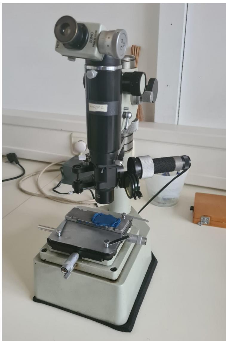
Slika 27. Mikrotvrdomjer PMT-3
