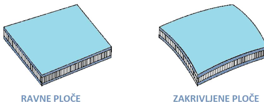
Slika 3.1. Ravni i zakrivljeni elementi sendvič konstrukcije [4]
