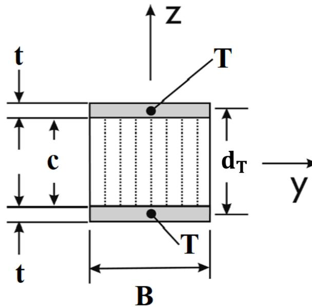
Slika 3.2. Simetrični poprečni presjek sendvič grede [4]
