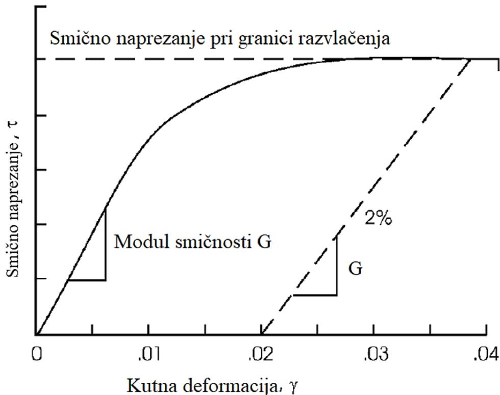
Slika 4.5. Dijagram ovisnosti smičnog napreznja o kutnoj deformaciji [4]
