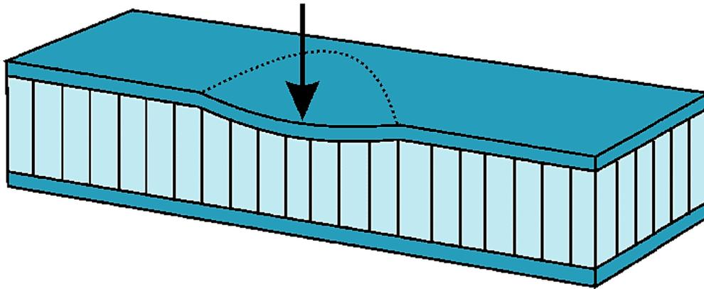
Slika 3.12. Lokalno oštećenje uslijed koncentriranog opterećenja [4]
