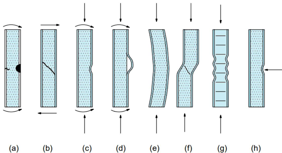
**Slika 3.14. Mogući mehanizmi popuštanja sendvič kompozita: (a) popuštanje vanjskih slojeva; (b) smični lom jezgre; (c) i (d) boranje vanjskih slojeva; (e) opće izvijanja; (f) izvijanje uslijed smicanja; (g) boranje jezgre; (h) popuštanje uslijed koncentriranih napreznja [5]**
