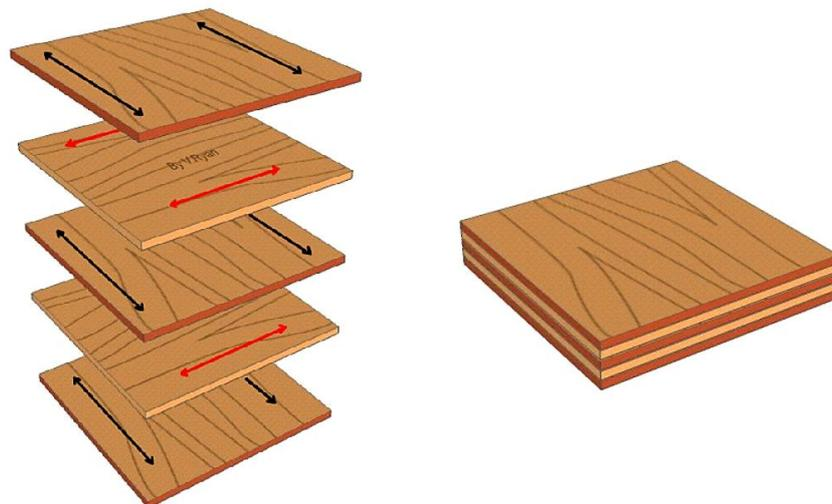
**Slika 2.3. Prikaz slojeva i spojene šperploče [3]**
