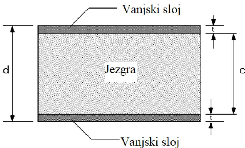
Slika 4.4. Dimenzije debljina dijelova sendvič panela [12]
