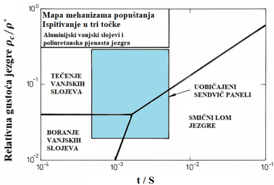
Slika 3.13. Mapa za određivanje mehanizma popuštanja sendvič panela [8]
