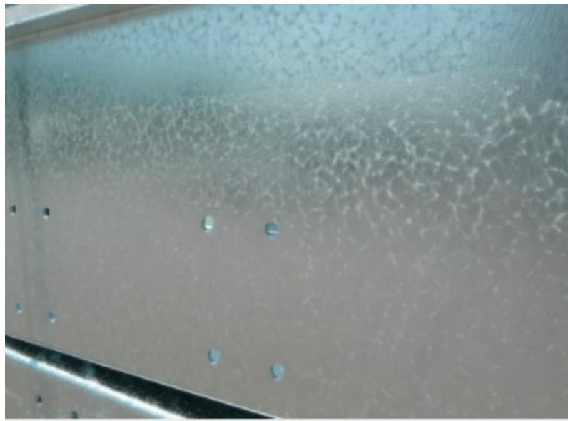
Slika 8 Specifični izgled površine uslijed Sandelin efekta [7]
