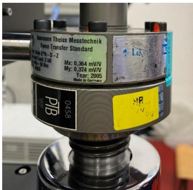
Slika 10. Dinamometar 116/KTN-5Kn
