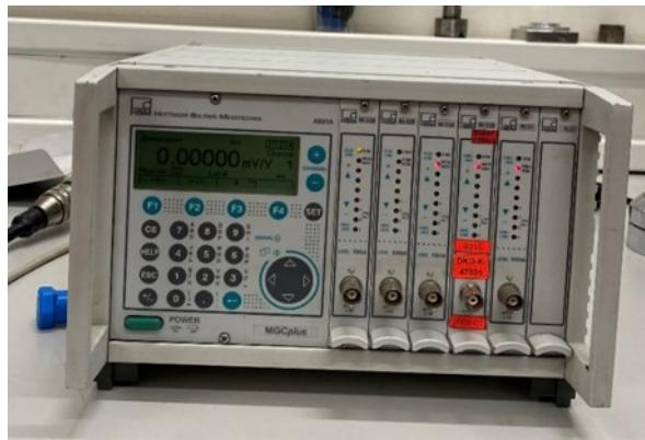
**Slika 11. Mjerno pojačalo Hottinger Baldwin Messtechnik**
