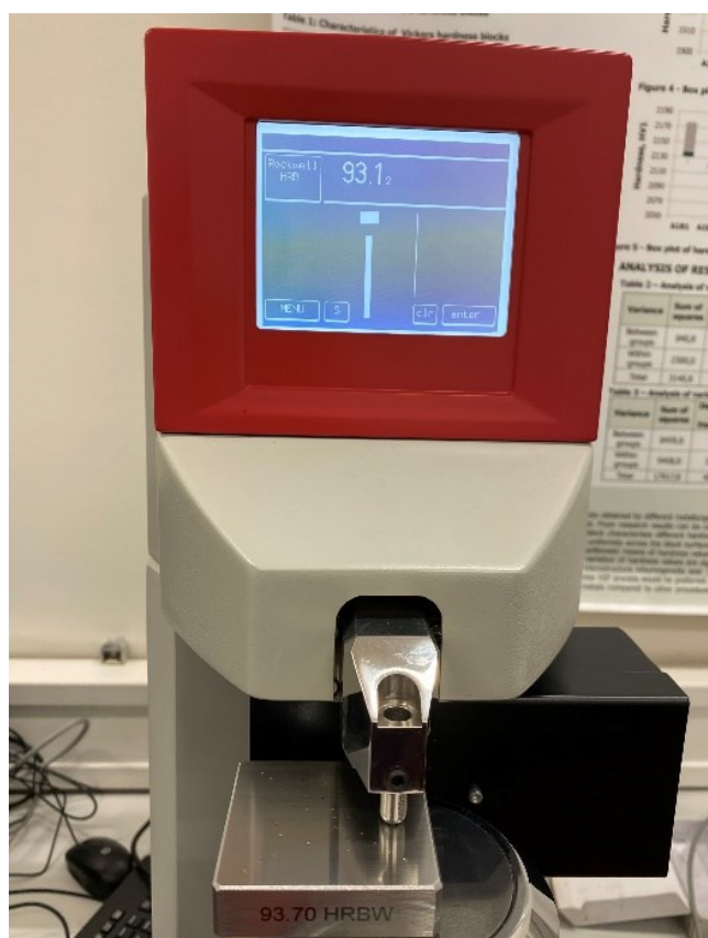
Slika 15. Proces mjerenja tvrdoće
