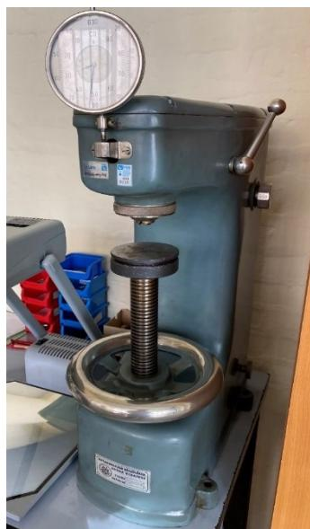
**Slika 14. Analogni tvrdomjer**
