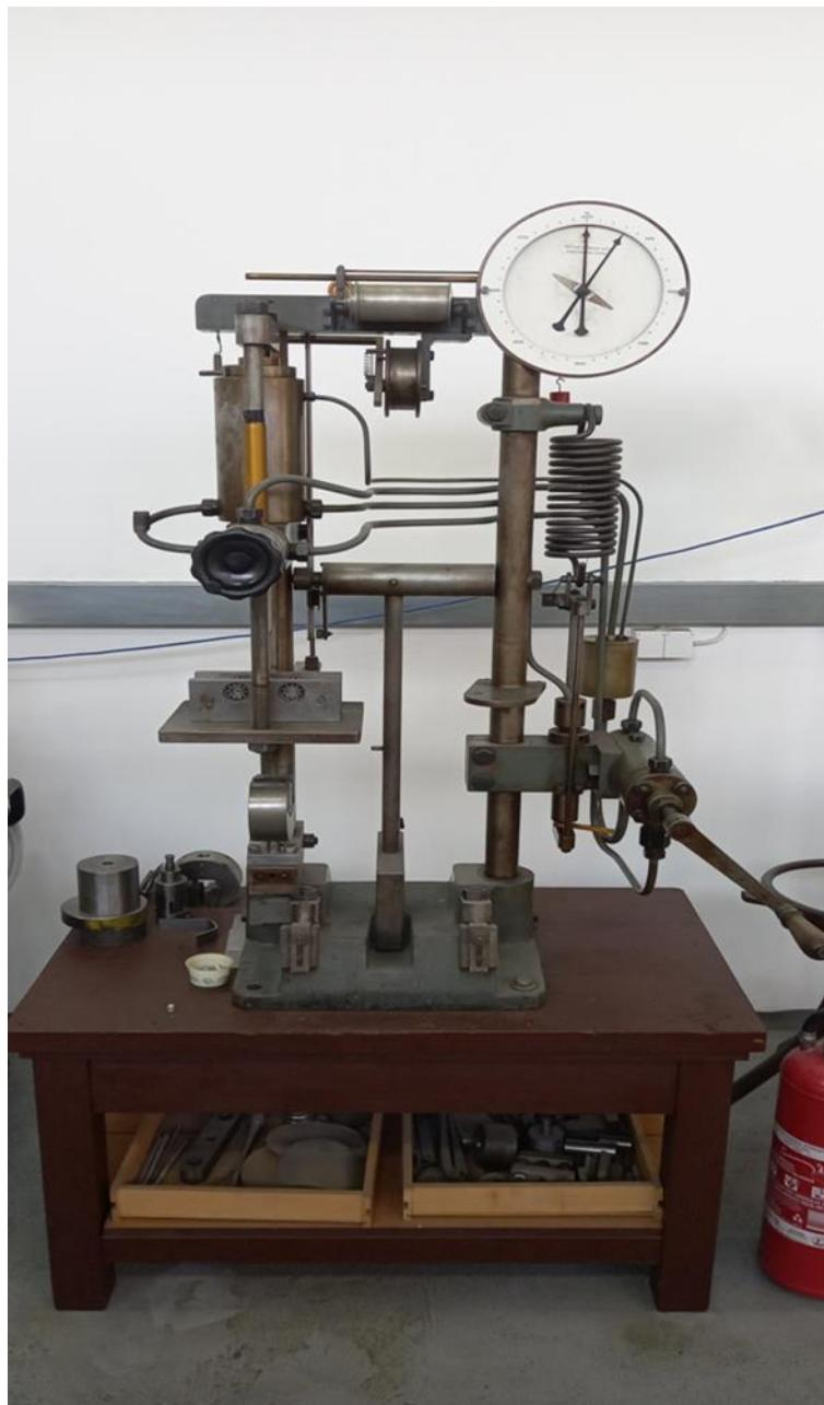
**Slika 11. Uredaj za savijanje u Laboratoriju za oblikovanje deformiranjem**
