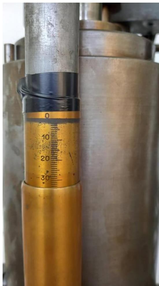
Slika 14. Uređaj za očitavanje elastičnog povrata
