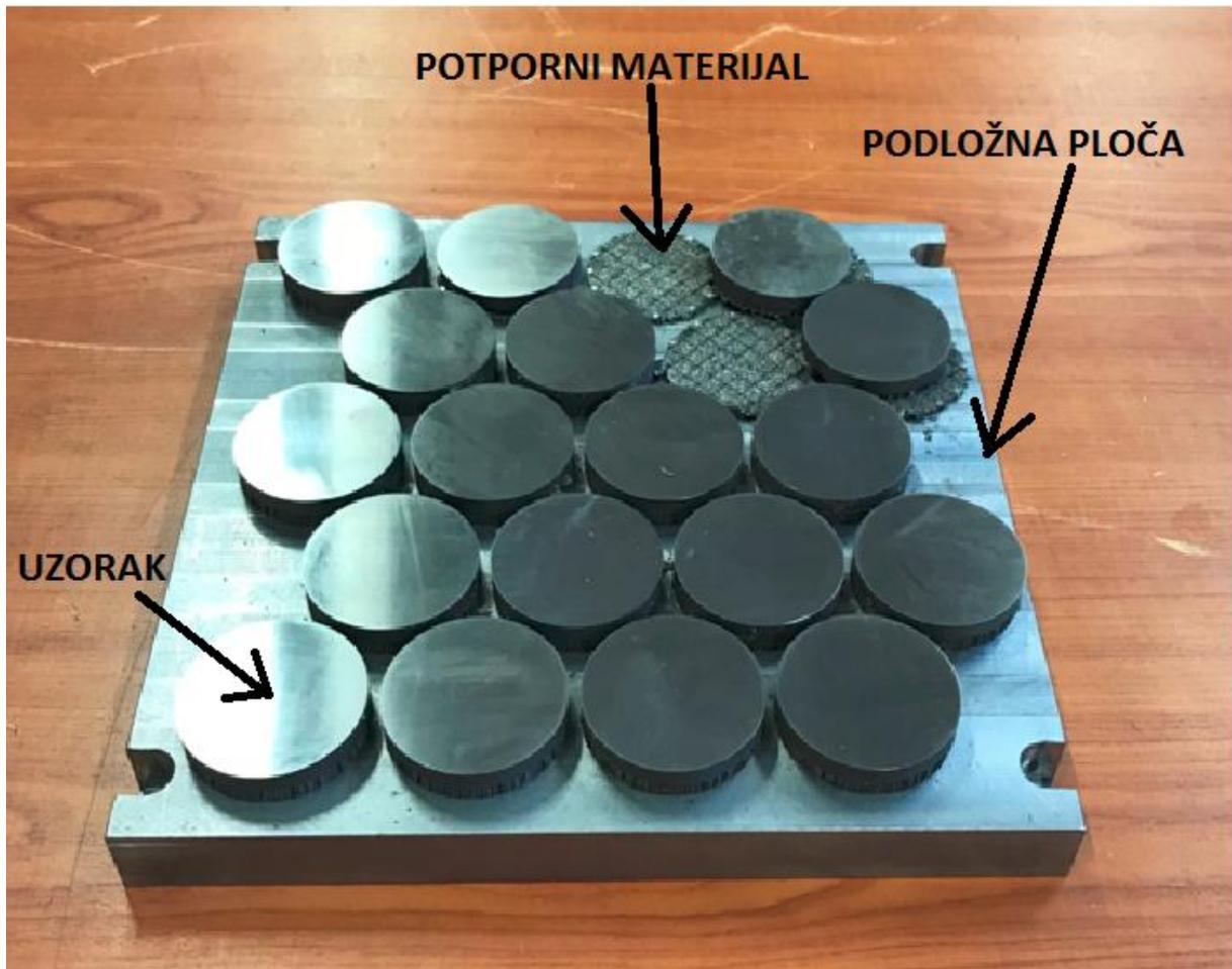
Slika 15. Etalonske pločice tvrdoće napravljene pomoću EOS M 290 uređaja
