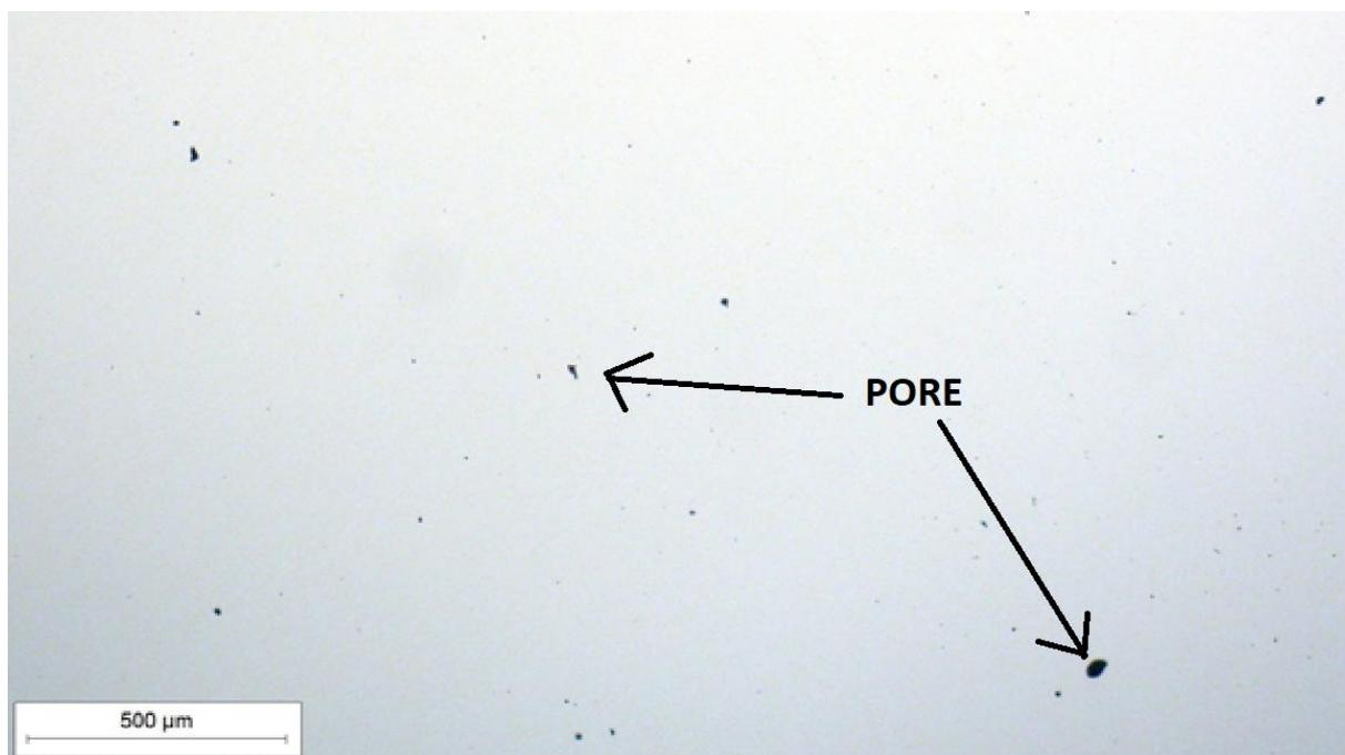
Slika 28. Prikaz mikrostrukture u poprečnom smjeru poliranog uzorka pri povećanju 50x
