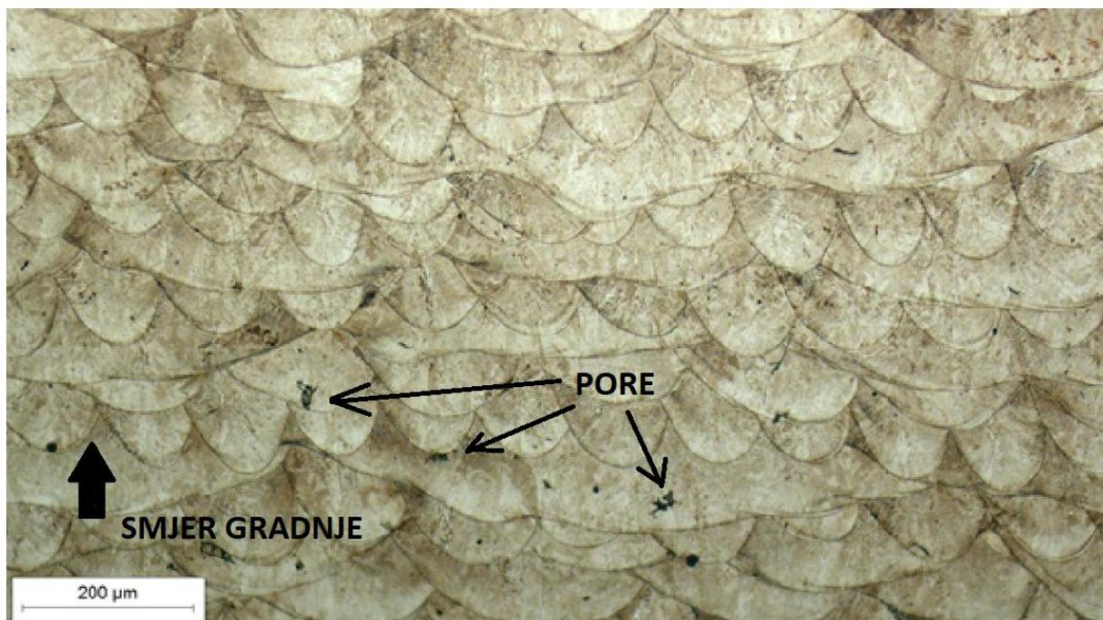
Slika 32. Prikaz mikrostrukture u poprečnom smjeru nagriženog uzorka pri povećanju 100x
