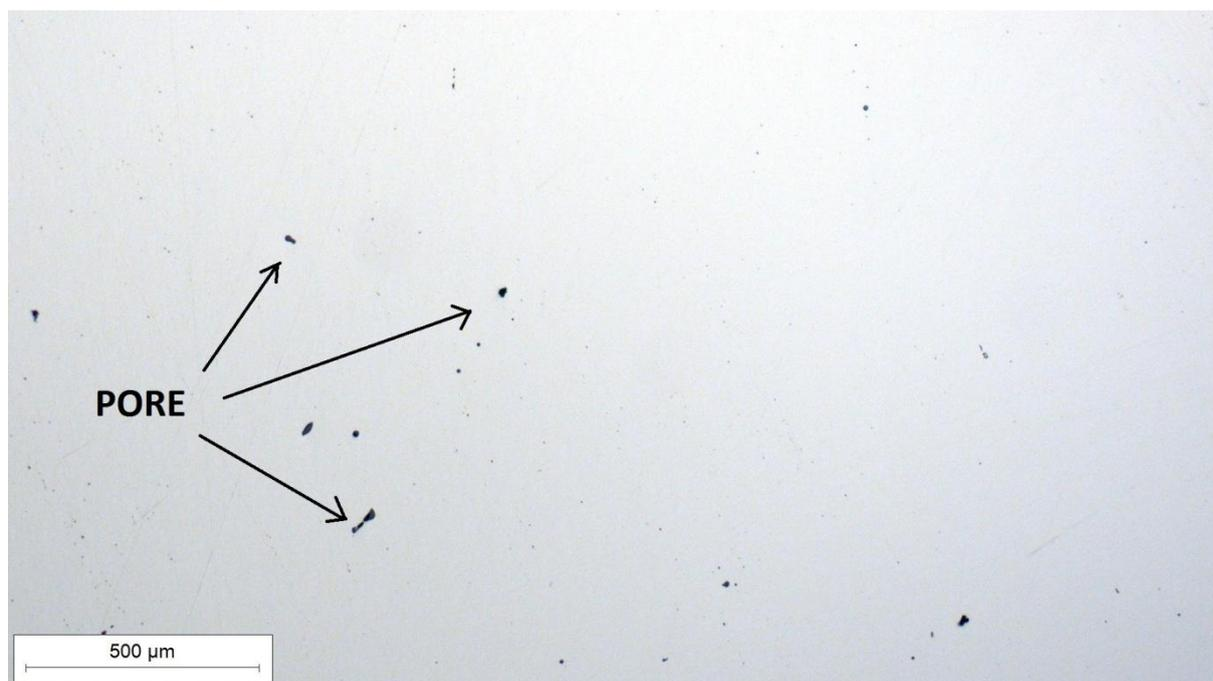
Slika 27. Prikaz mikrostrukture u uzdužnom smjeru poliranog uzorka pri povećanju 50x
