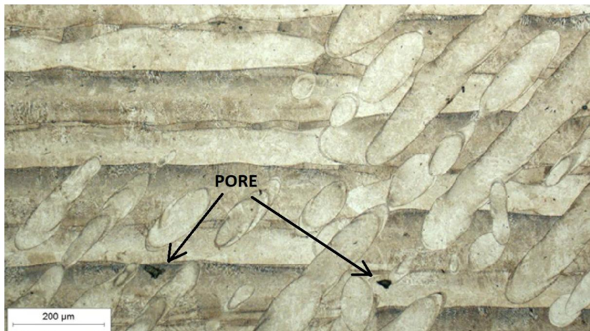
Slika 30. Prikaz mikrostrukture u uzdužnom smjeru nagriženog uzorka pri povećanju 100x
