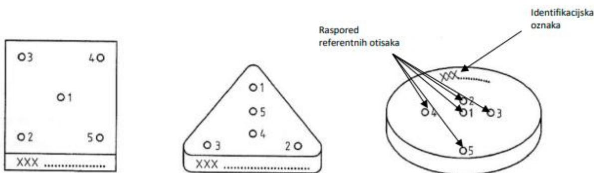
Slika 1. Oblici etalonskih pločica tvrdoće po Vickersu [2]
