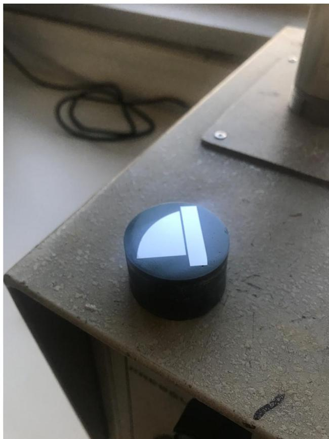
**Slika 25. Prikaz poliranog uzorka**
