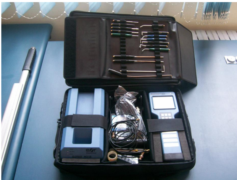
Slika 7: Tipičan komplet za ispitivanje vrtložnim strujama
