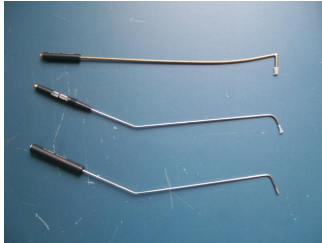
Slika 12: Standardne (pencil) sonde
