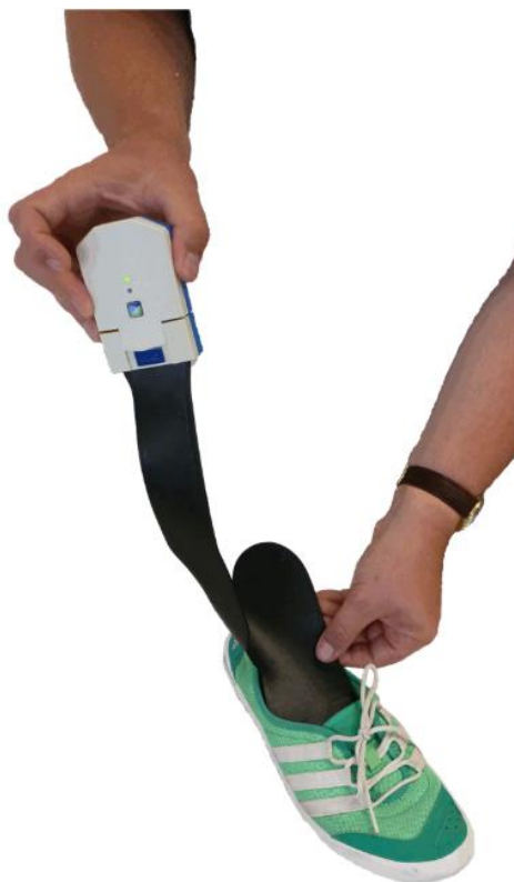
Slika 33. Uređaj Medilogic WLAN Insole
