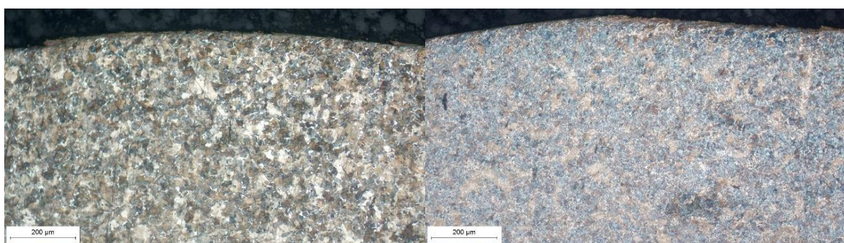
Slika 22. Rubovi nežarenog (lijevo) i žarenog uzorka (desno) pod povećanjem od 100x
