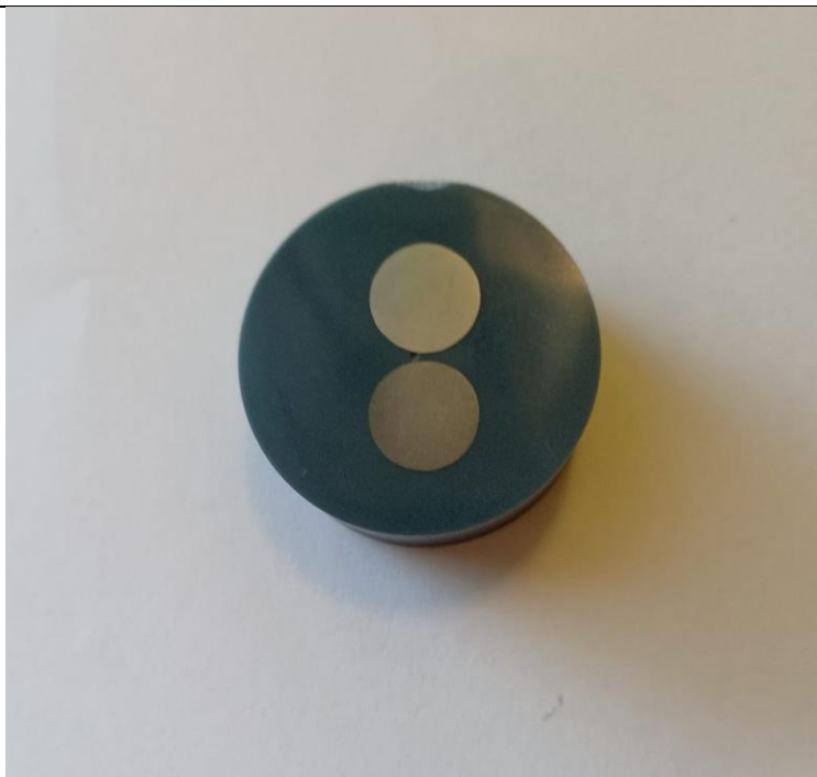
Slika 18. Izrezani uzorci u polimernoj masi
