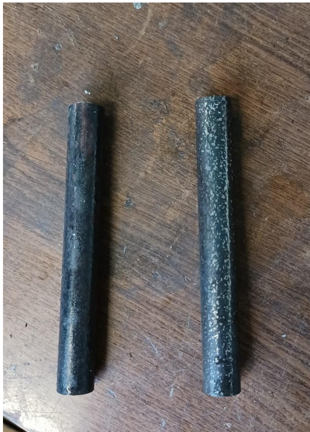
Slika 14. Žareni uzorak (lijevo) i nežareni uzorak (desno)
