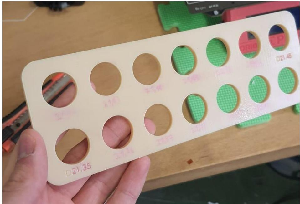
Slika 66. Testni držač čelija s različitim dimenzijama provrta
