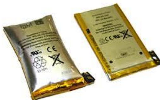
Slika 18. Prikaz bubrenja pouch ćelije [19]
