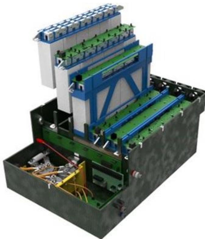
Slika 15. FS Stuttgart 2019 baterijski paket [16]
