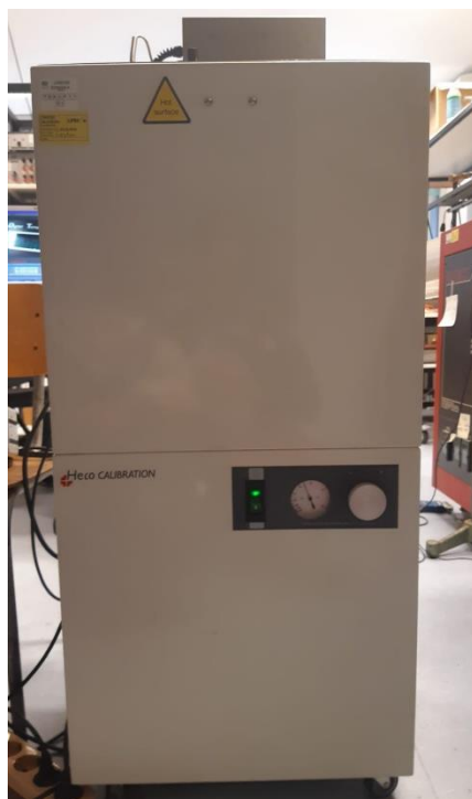
Slika 1. Kupka Heto Calibration KB22-1
