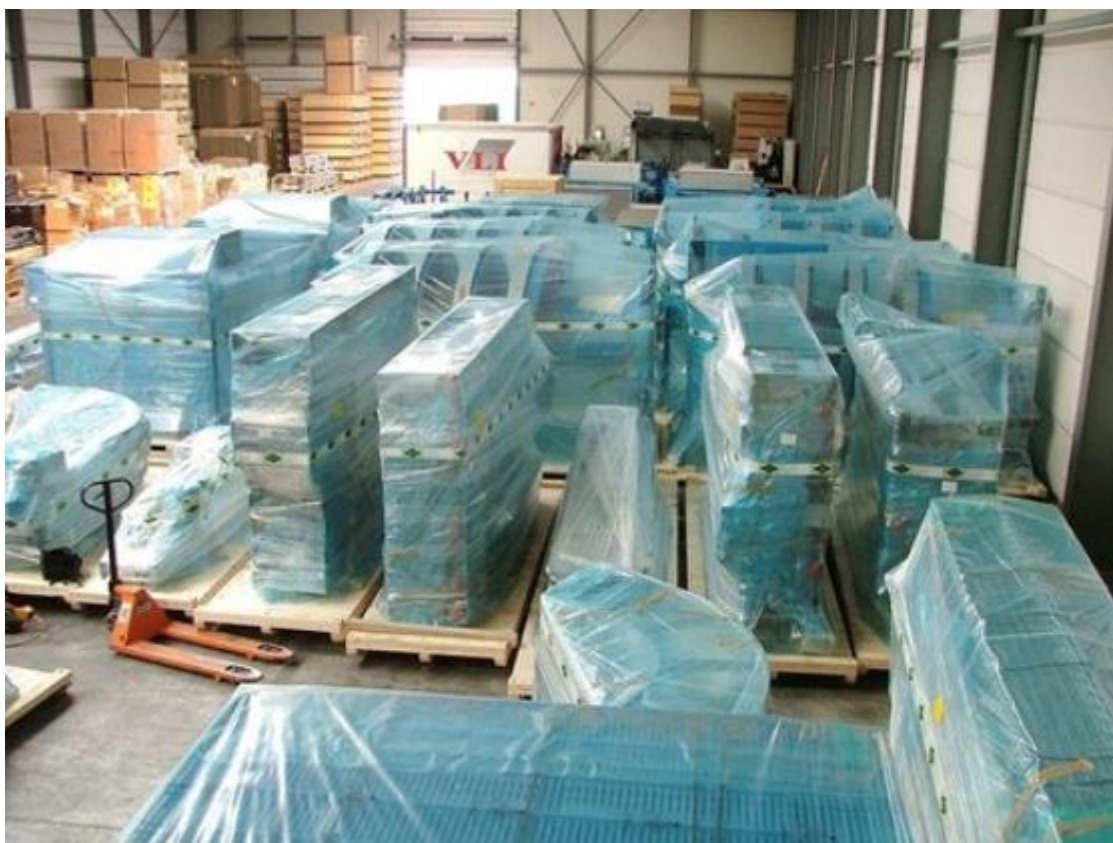
Slika 9. Skladištenje elemenata zaštitnom folijom s inhibitorima korozije [17]
