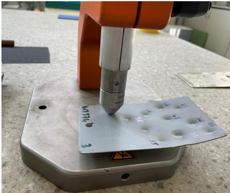
Slika 20. Ispitivanje otpornosti premaza na udar
