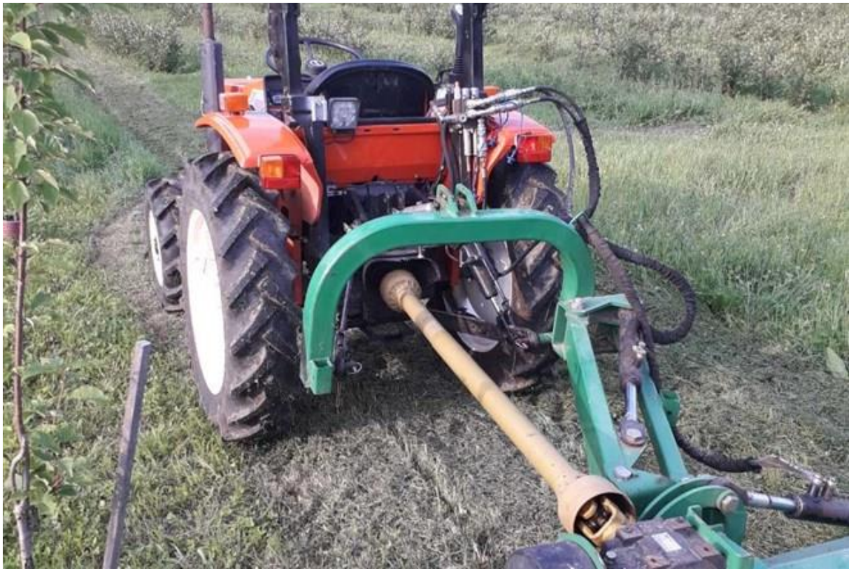
Slika 7. Kardansko vratilo spojeno na traktor (žuto) [8]
