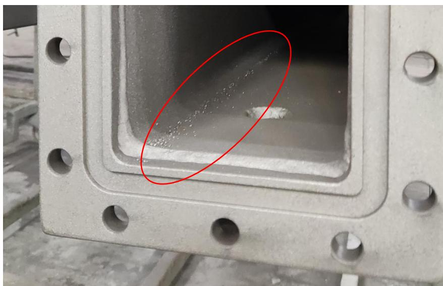
Slika 28. Nepravilnosti na površini
