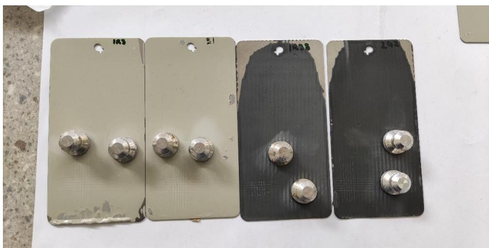
Slika 39. Čunjići zalijepljeni na ispitne uzorke
