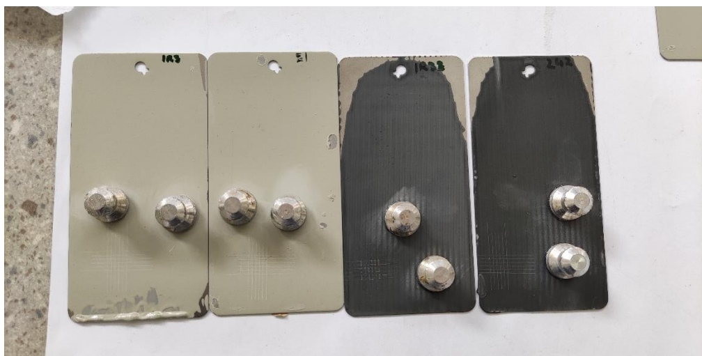
Slika 39. Čunjići zalijepljeni na ispitne uzorke
