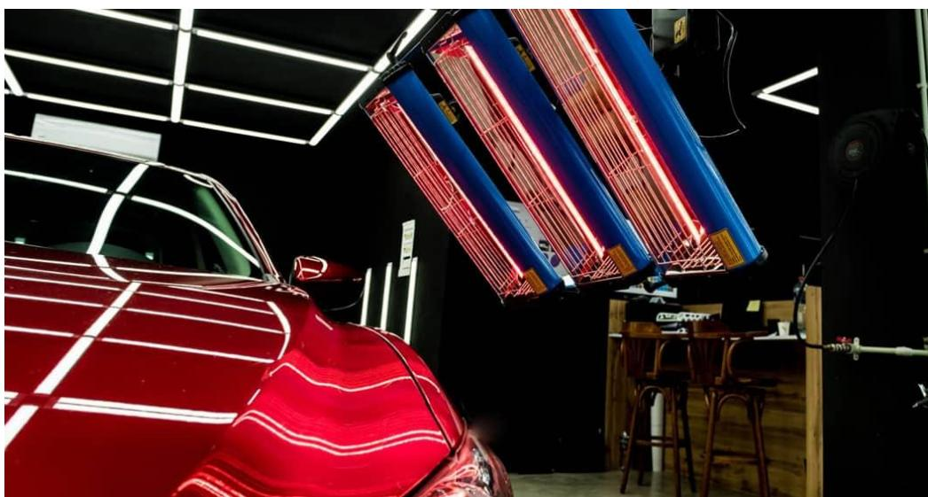
Slika 23. IC sušenje premaza automobila [26]
