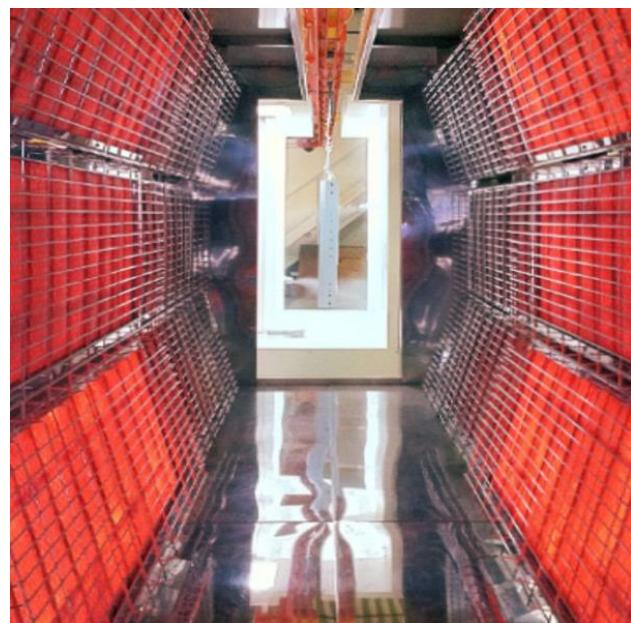
**Slika 18. Komora za katalitičko IC sušenje premaza [23]**
