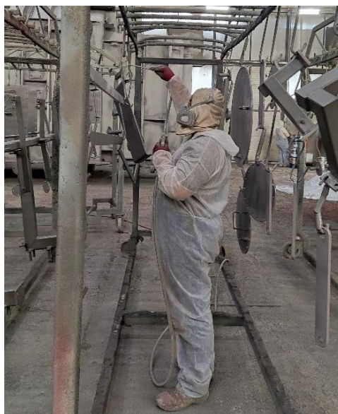
Slika 26. Nanošenje premaza zračnim prskanjem
