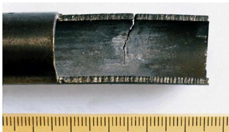
Slika 8. Napetosna korozija [5]
