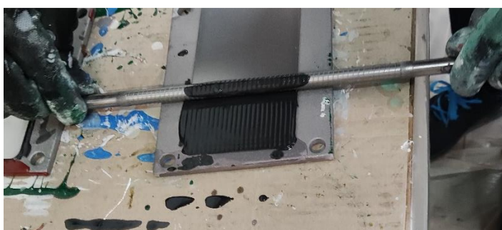
Slika 33. Nanošenje premaza spiralnim aplikatorom
