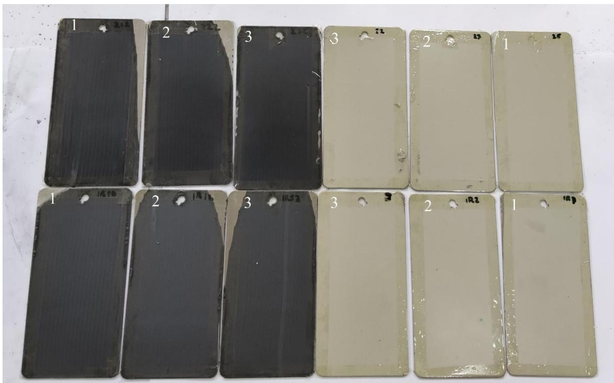
Slika 62. Uzorci pripremljeni za uranjanje u kiseline
