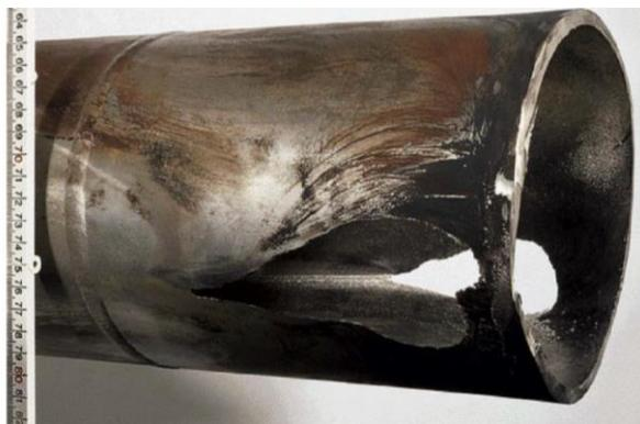
Slika 7. Erozijska korozija [5]
