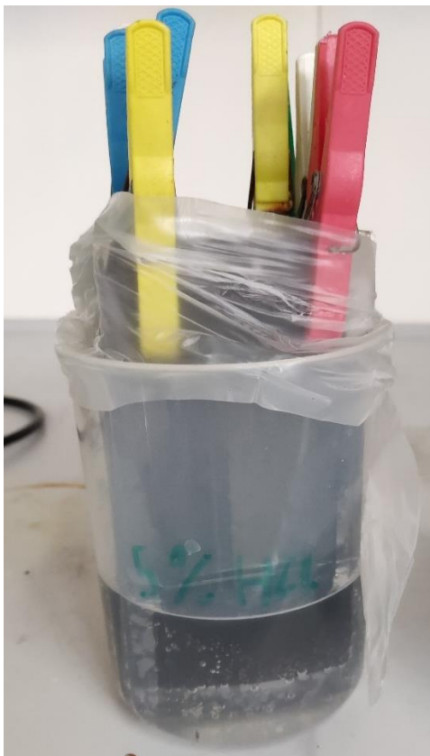
Slika 65. Uzorci uronjeni u 5 %-tnu HCl
