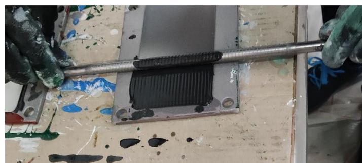
Slika 33. Nanošenje premaza spiralnim aplikatorom
