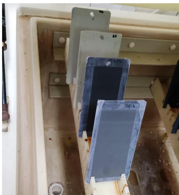
Slika 59. Uzorci u vlažnoj komori 1. dan
