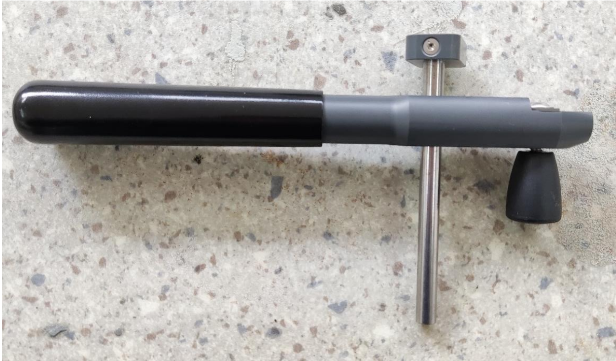
Slika 57. Alat za urezivanje
