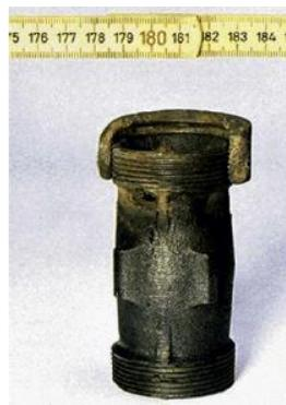
Slika 2. Galvanska (bimetalna) korozija [5]
