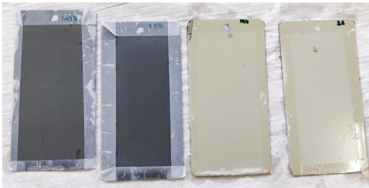
Slika 60. Uzorci izloženi u vlažnoj komori 3.dan
