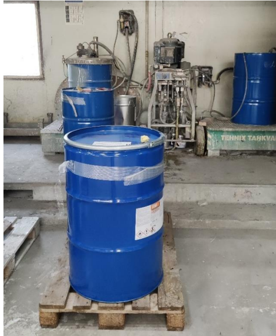
Slika 25. Skladištenje premaza i uređaj za miješanje
