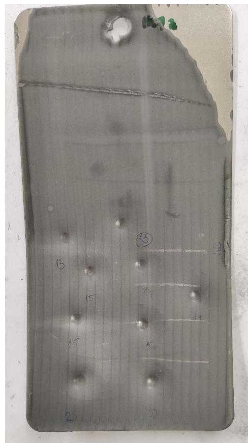
Slika 43. Uzorak ispitivanja udarom
