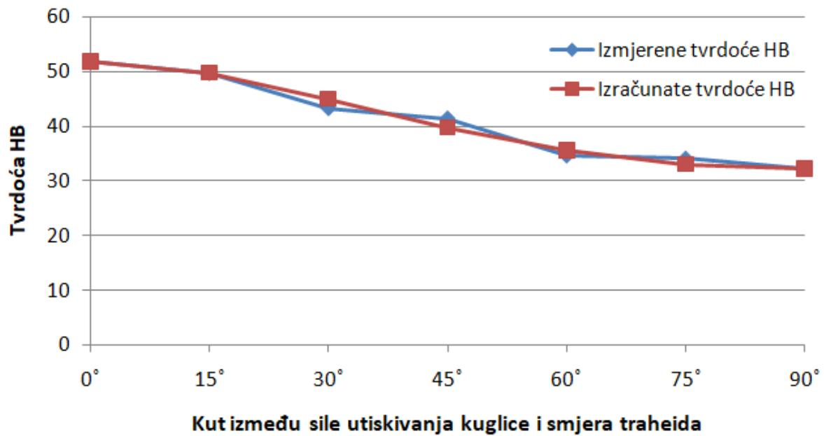
Slika 5.20 Izmjerene i izračunate promjene tvrdoće HB
