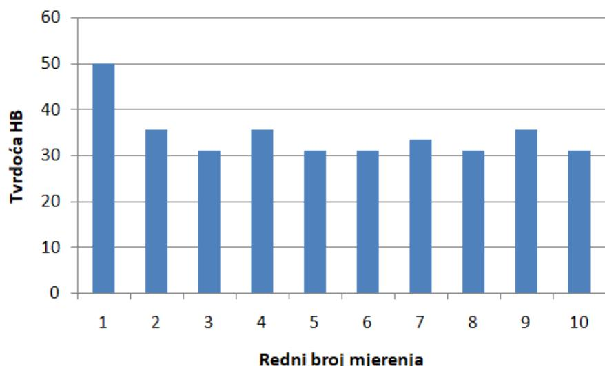
Slika 5.15 Rezultati mjerena tvrdoće HB na uzorku oznake 60°R
