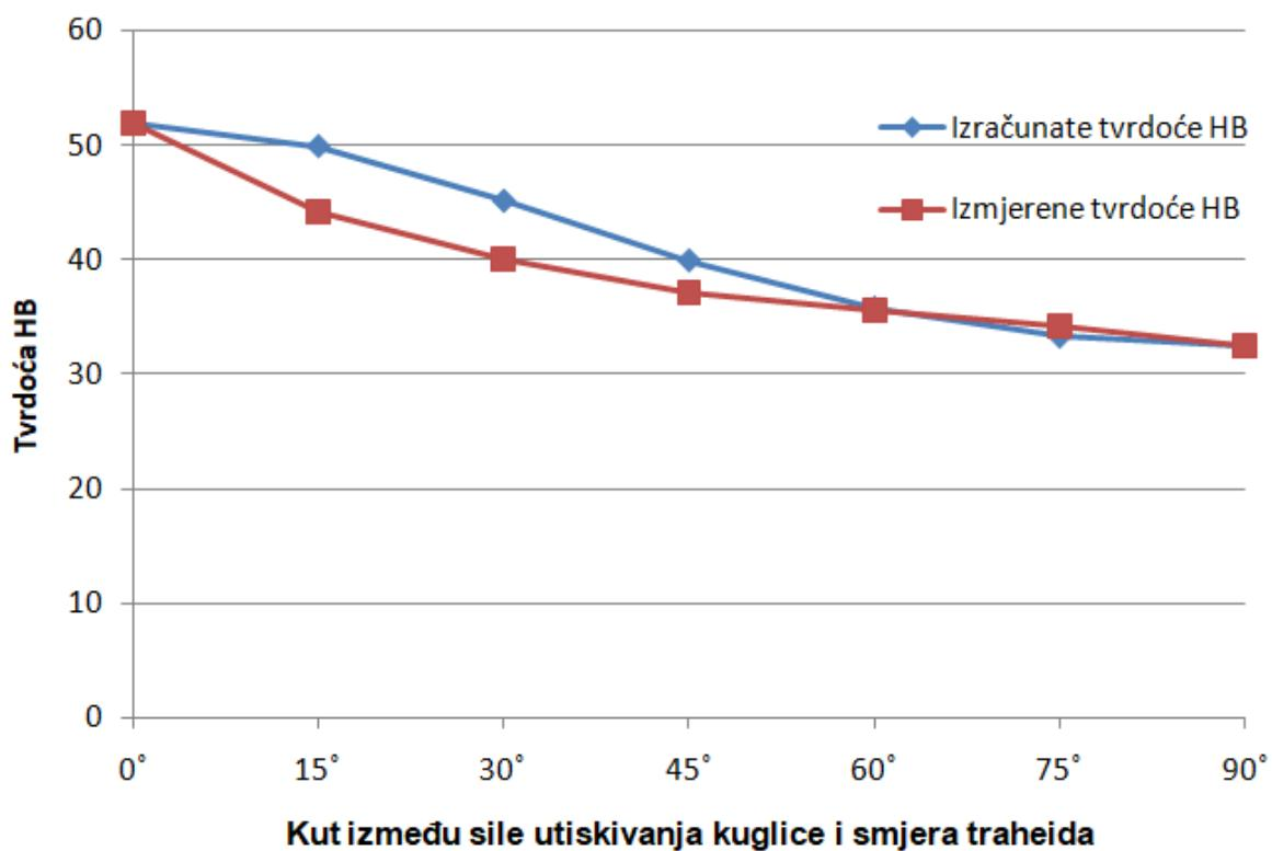
**Slika 5.10 Izmjerene i izračunate promjene tvrdoće HB**
