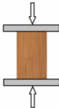
**Slika 3.4 Shematski prikaz ispitivanja tlačne čvrstoće [1]**
