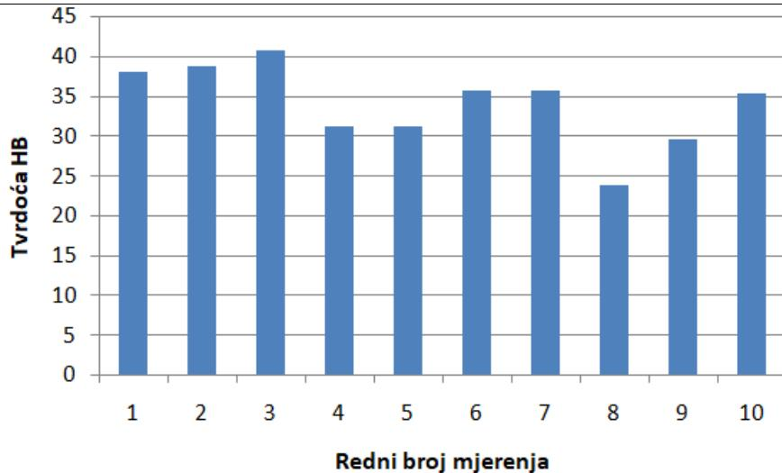
Slika 5.16 Rezultati mjerena tvrdoće HB na uzorku oznake 75°R
