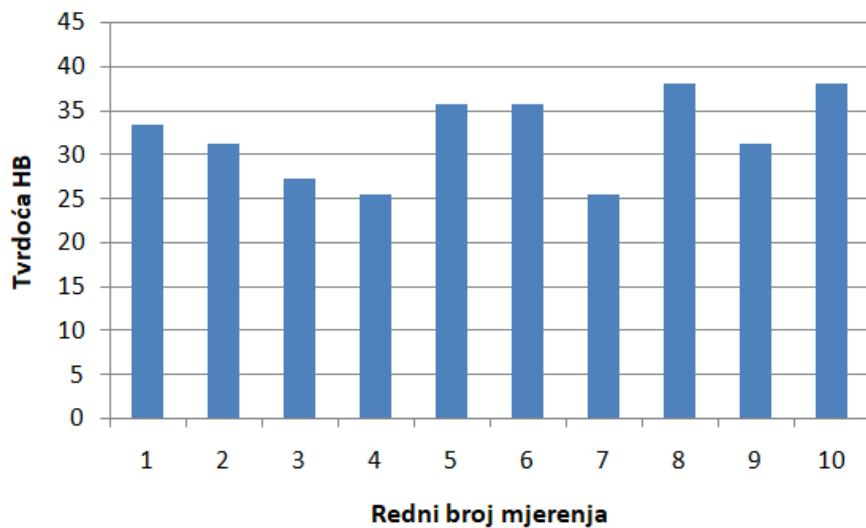
Slika 5.17 Rezultati mjerena tvrdoće HB na uzorku oznake 90°R
