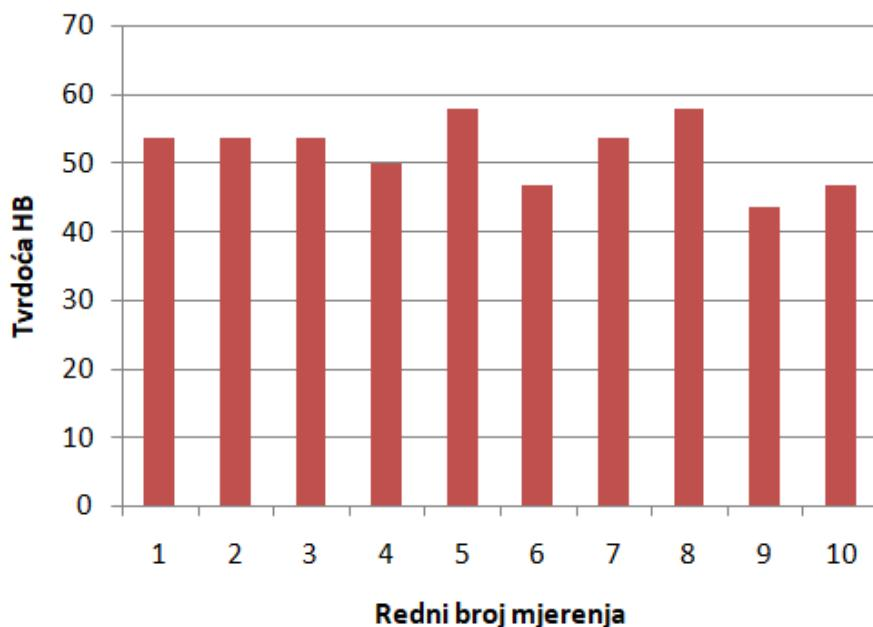
Slika 5.1 Rezultati mjerjenja tvrdoće HB na uzorku označke  $0^\circ T$
