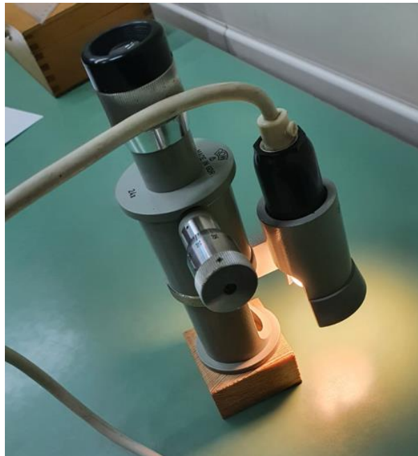
Slika 4.12 Uređaj za precizno mjerenje promjera otiska
