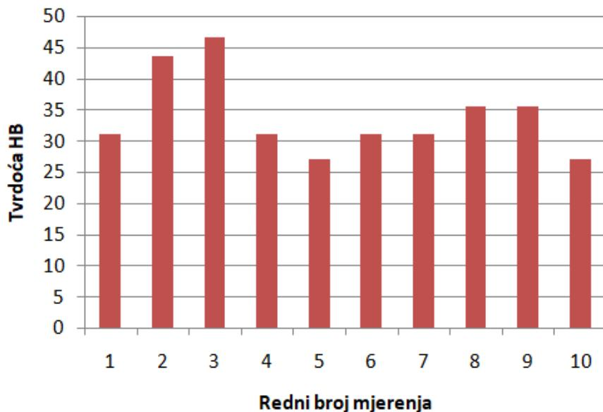
Slika 5.6 Rezultati mjerjenja tvrdoće HB na uzorku oznake  $75^{\circ}\text{T}$
