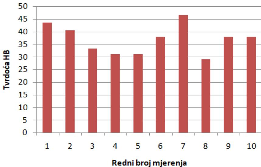
Slika 5.4 Rezultati mjerena tvrdoće HB na uzorku oznake  $45^{\circ}\text{T}$
