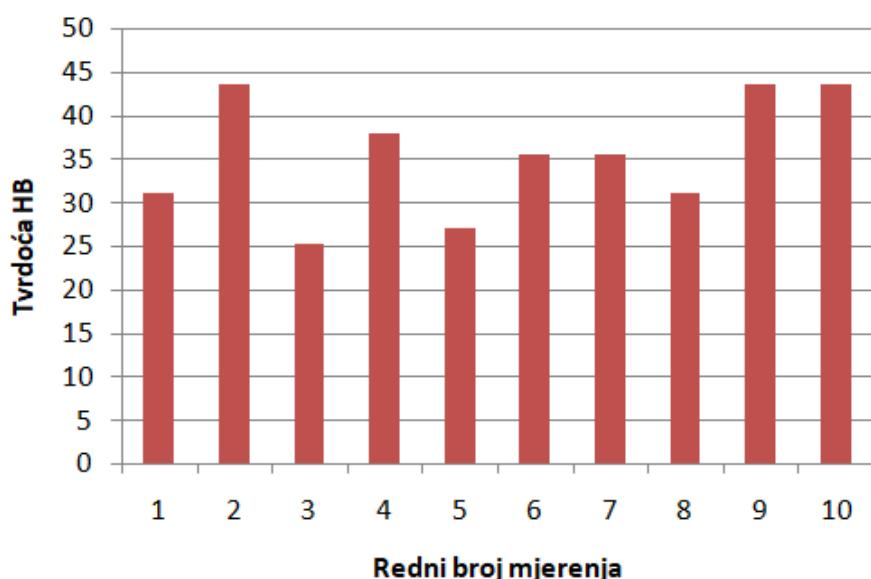
Slika 5.5 Rezultati mjerena tvrdoće HB na uzorku oznake  $60^{\circ}\text{T}$
