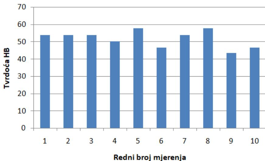
Slika 5.11 Rezultati mjerjenja tvrdoće HB na uzorku označe  $0^\circ R$
