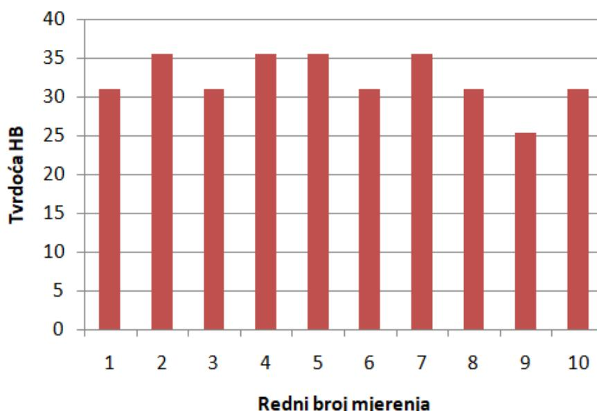
Slika 5.7 Rezultati mjerjenja tvrdoće HB na uzorku oznake  $90^{\circ}\text{T}$
