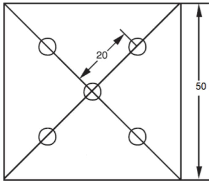
**Slika 4.3 Shematski prikaz pozicija za mjerjenje tvrdoće na uzorcima**
