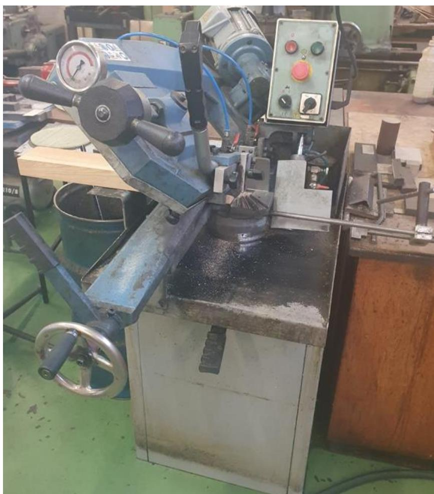
**Slika 4.2 Tračna pila**
