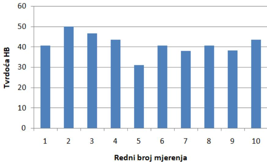
Slika 5.14 Rezultati mjerena tvrdoće HB na uzorku oznake 45°R
