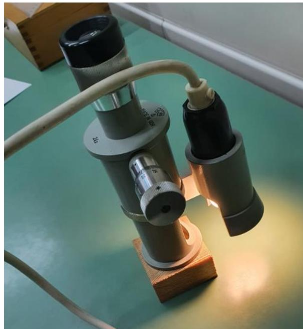
**Slika 4.12 Uređaj za precizno mjerjenje promjera otiska**
