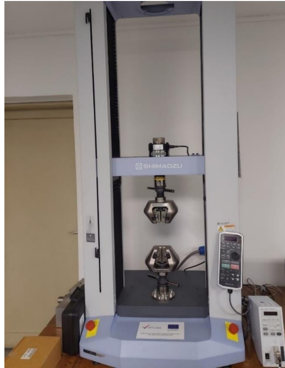
Slika 35. Shimadzu uređaj korišten za vlačno ispitivanje
