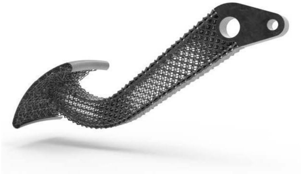
Slika 42. Pedala kočnice dizajnirana u programu nTopology [20].
