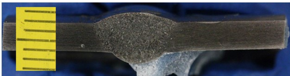
Slika 35. Makrostruktura zavarenog spoja
