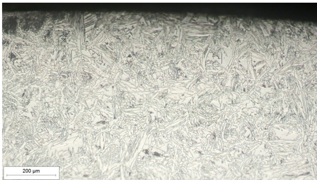
Slika 46. Mikrostruktura metala zavara u tjemenu zavara, snimljena pri povećanju 100×
