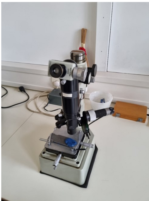
Slika 50. Mikrotvrdomer, model PMT-3.
