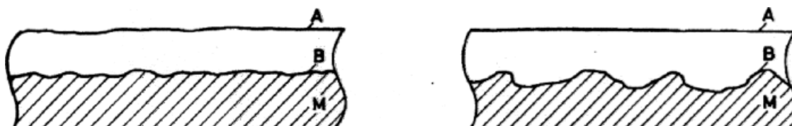
Slika 5. Ravnomjerna (lijevo) i neravnomjerna (desno) opća korozija [12]
