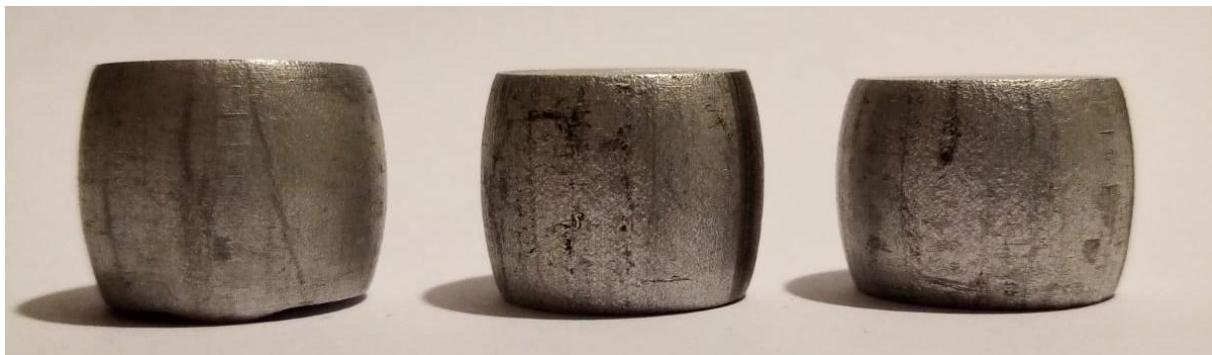
**Slika 22. Uzorci nakon deformacije gdje su kontaktne površine bile hrapavo – hrapavo**
