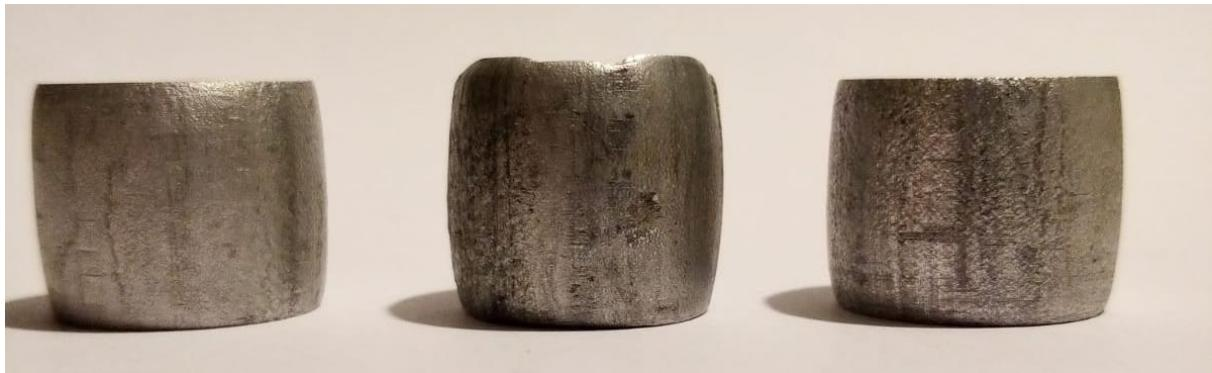
**Slika 25. Uzorci nakon deformacije gdje su kontaktne površine bile hrapavo – hrapavo**
