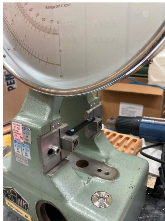
Slika 26: Položaj epruvete na uređaju za mjerenje udarne žilavosti
