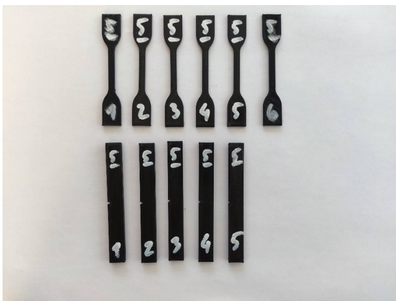
Slika 17: Epruvete 5. serije - bez TO
