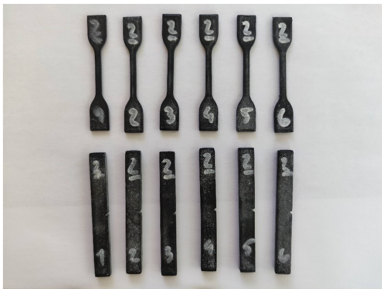
Slika 14: Epruvete 2. serije - sol pri 170 °C
