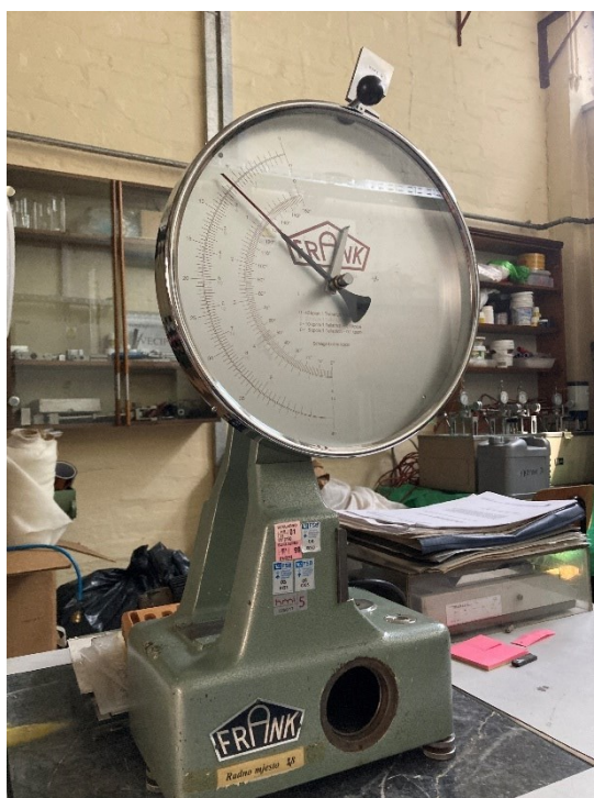
Slika 24: Uređaj marke Frank za ispitivanje udarne žilavosti
