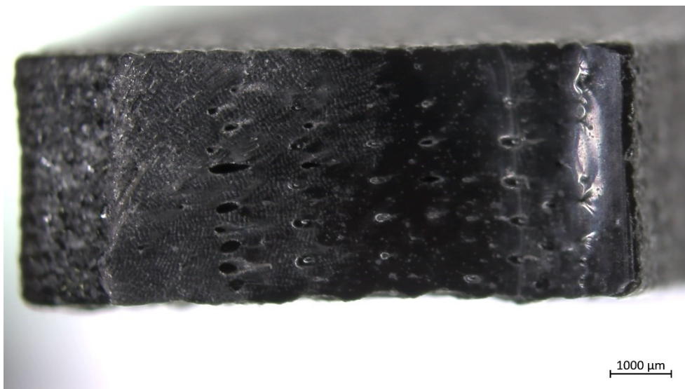
Slika 35: Primjer epruvete 2 - presjek nakon rasteznog pokusa
