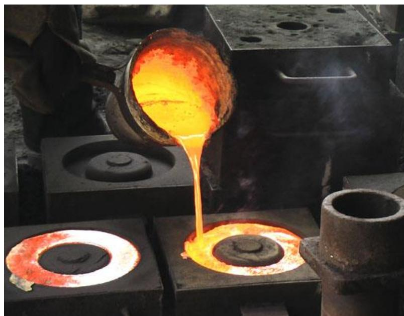
Slika 1. Lijevanje u kokilu [2]
