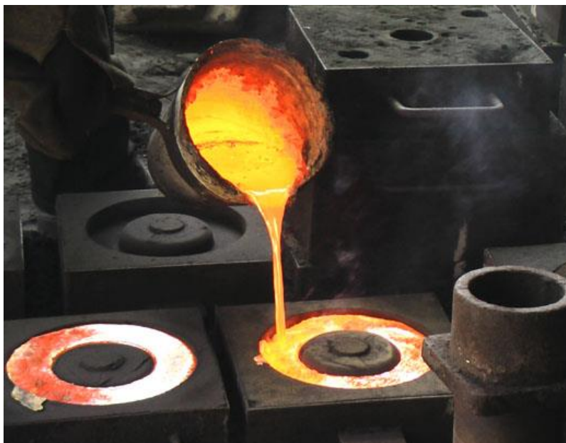
Slika 1. Lijevanje u kokilu [2]
