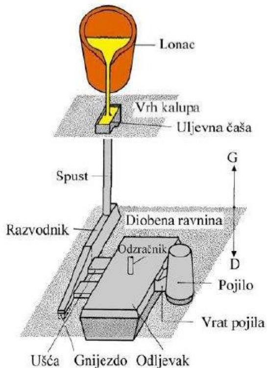
Slika 19. Dijelovi uljevnog sustava [5]
