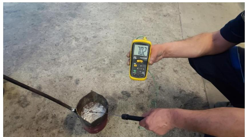
Slika 56. Temperatura lijevanja
