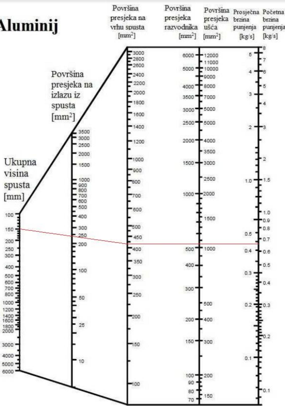
Slika 28. Određivanje dimenzija uljevnog sustava [13]
