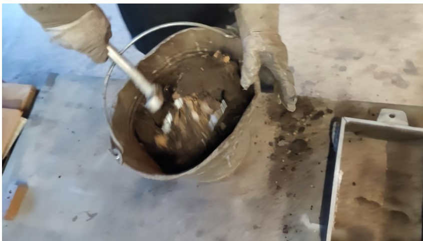
Slika 60. Čišćenje odljevka od kalupne mješavine
