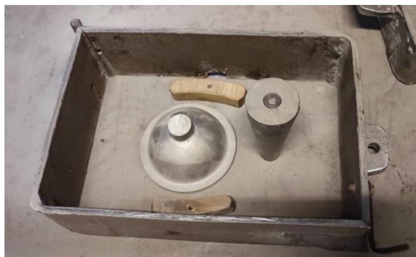
Slika 41. Položaj uljevnog sustava
