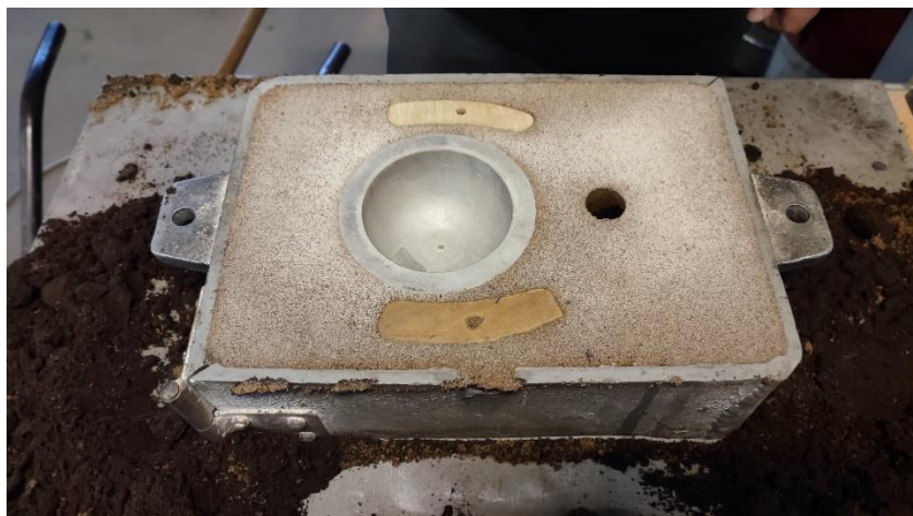
Slika 46. Model poklopca i razvodnika u gornjaku
