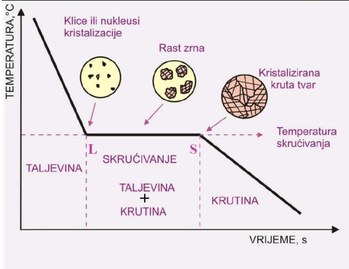
Slika 6. Shematski prikaz krivulje hlađenja čistog metala [5]
