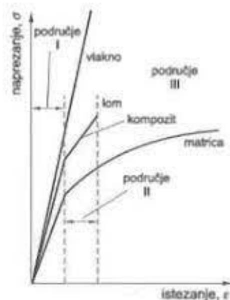
Slika 4. Dijagram naprezanje-istezanje vlaknima ojačanog kompozita [1]
