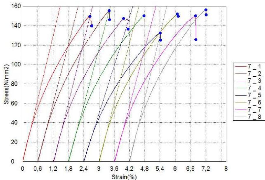
**Slika 27. Graf naprezanje - istezanje kod savojnog ispitivanja (sedam slojeva vlakana)**
