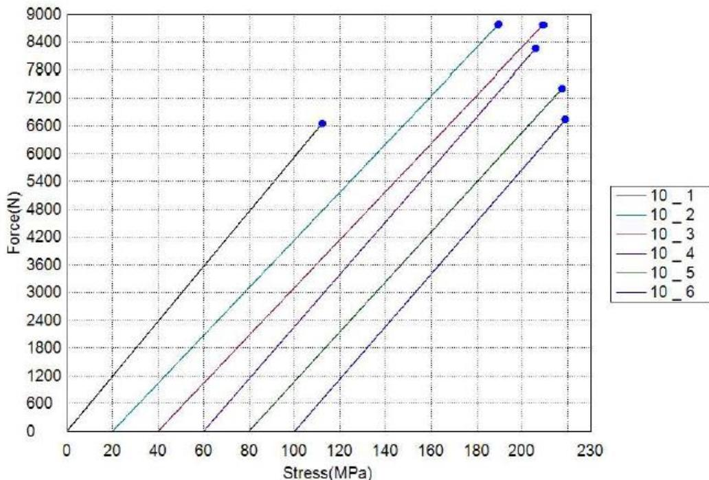
**Slika 22. Graf sile - progib kod ispitivanja prividne međuslojne smične čvrstoće (deset slojeva vlakana)**
