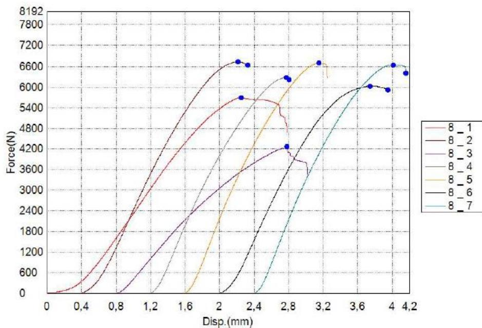
**Slika 20. Graf sile - progib kod ispitivanja prividne međuslojne smične čvrstoće (osam slojeva vlakana)**
