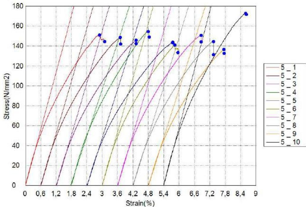
Slika 25. Graf naprezanje - istezanje kod savojnog ispitivanja (pet slojeva vlakana)
