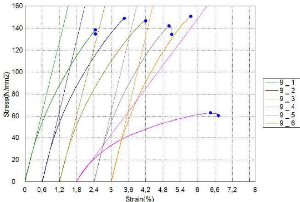
**Slika 29. Graf naprezanje - istezanje kod savojnog ispitivanja (devet slojeva vlakana)**
