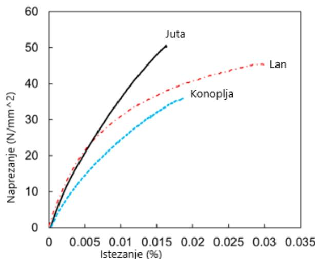
Slika 11. Statičko rastezno ispitivanje prirodnih vlakana [10]
