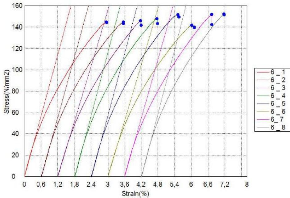
Slika 26. Graf naprezanje - istezanje kod savojnog ispitivanja (šest slojeva vlakana)
