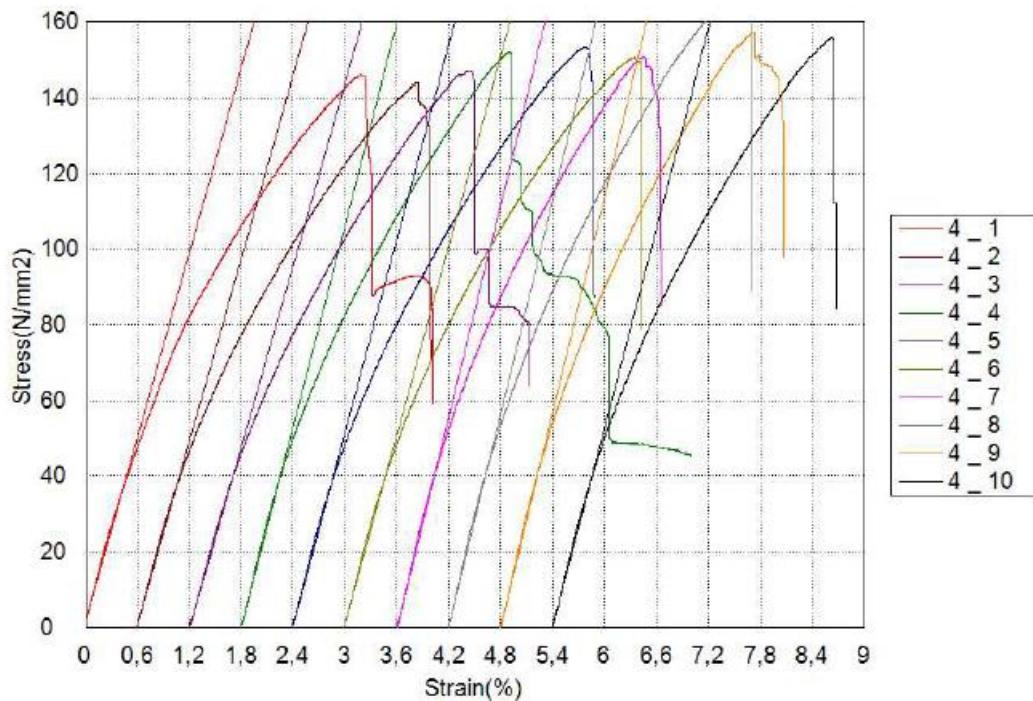
**Slika 24. Graf naprezanje - istezanje kod savojnog ispitivanja (četiri sloja vlakana)**
