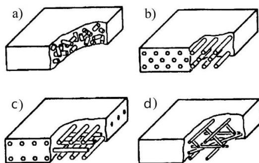
**Slika 3. Raspored vlakana u matrici:** (a) kratka, proizvoljno orijentirana, (b) duga, u jednom smjeru orijentirana, (c) duga, u dva okomita smjera orijentirana i (d) duga, isprepletena, proizvoljno orijentirana [4]
