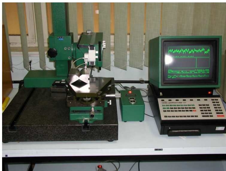
Slika 18. uređaj za mjerenje hrapavosti površine MU2-127
