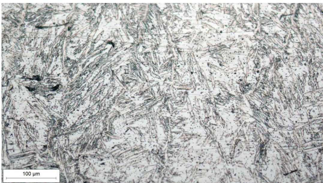
**Slika 39. Mikrostruktura navara uzorka 2A uz povećanje 200x**
