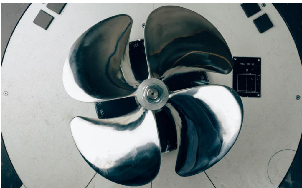
Slika 7. Brodski propeler izrađen iz dupleks nehrđajućeg čelika [12]
