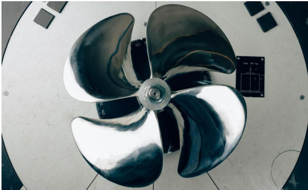
Slika 7. Brodski propeler izrađen iz dupleks nehrđajućeg čelika [12]
