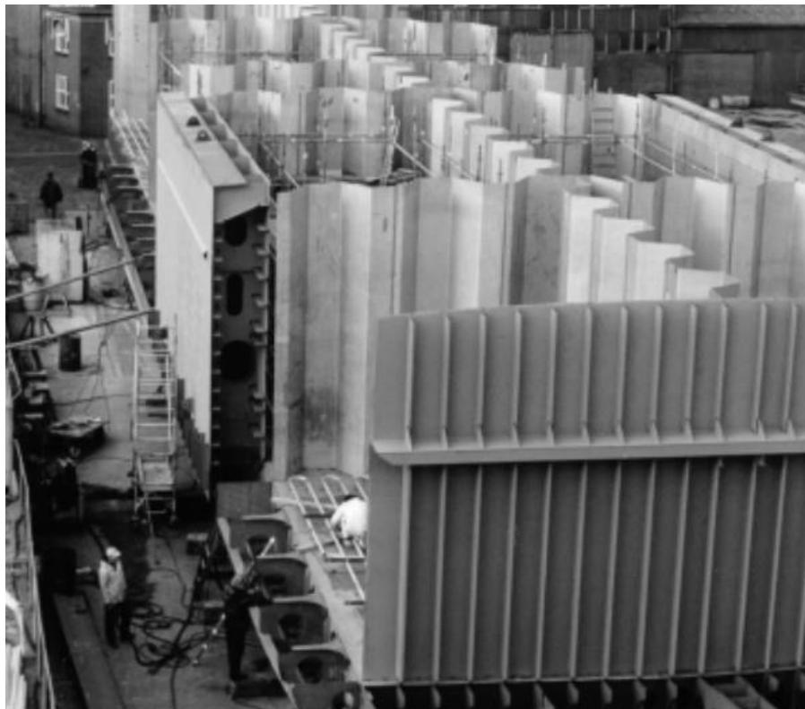
**Slika 5. Prikaz rasporeda spremnika za kemikalije na tankeru tijekom proizvodnje[10]**
