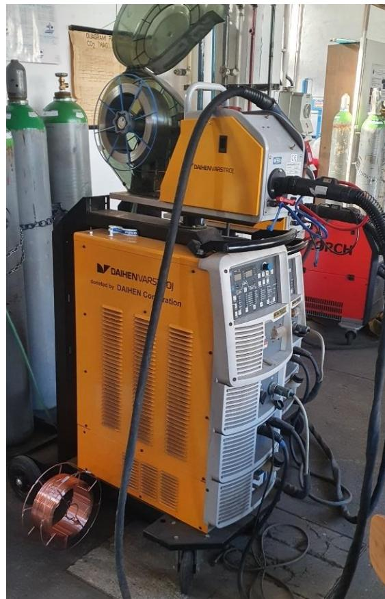
**Slika 19. Izvor struje DAIHEN Varstroj WB P-500L**
