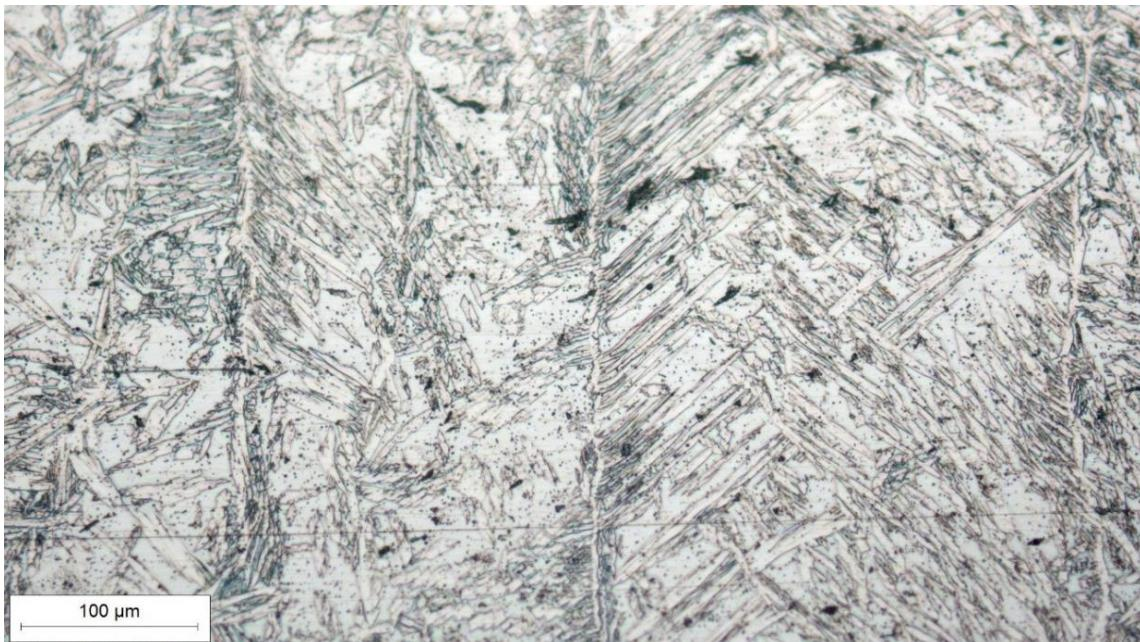
**Slika 40. Mikrostruktura navara uzorka 2B uz povećanje 200x**
