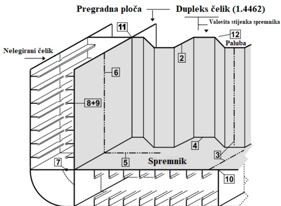
**Slika 6. Shematski prikaz presjeka spremnika tankera [8]**
