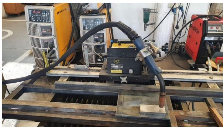
Slika 18. BUG-O Systems automatizirani sustav za zavarivanje
