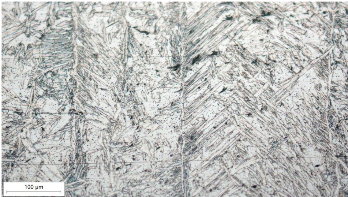
Slika 40. Mikrostruktura navara uzorka 2B uz povećanje 200x
