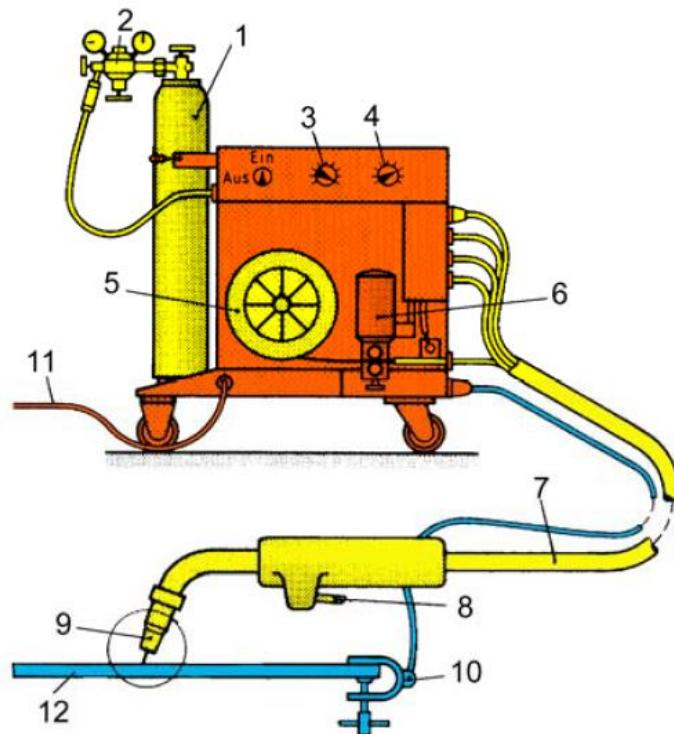
**Slika 17. Shema uređaja za MIG/MAG zavarivanje [17]**
