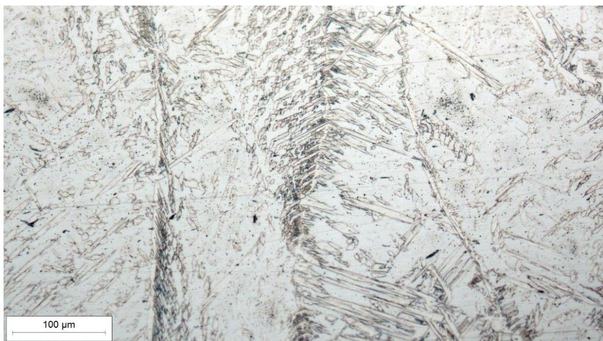
Slika 37. Mikrostruktura navara uzorka 1A uz povećanje 200x
