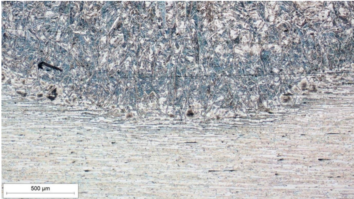
Slika 43. Mikrostruktura korijena navara uzorka 2A uz povećanje 50x
