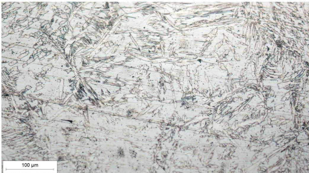
**Slika 38. Mikrostruktura navara uzorka 1B uz povećanje 200x**
