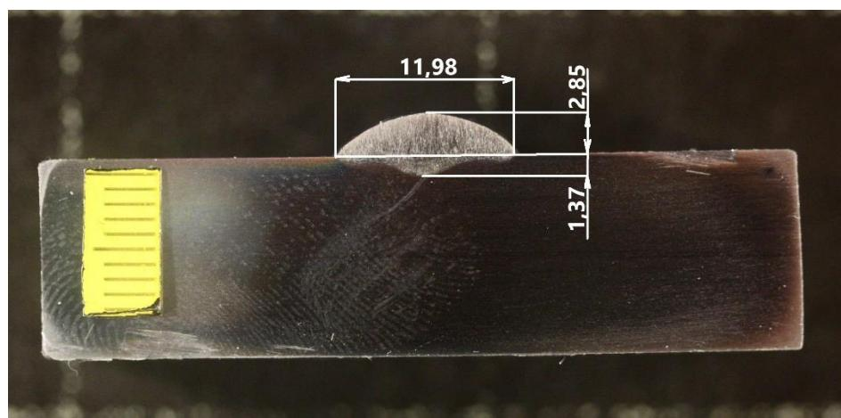
Slika 31. Geometrija navara uzorka 2B
