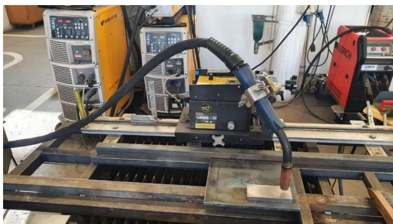
Slika 18. BUG-O Systems automatizirani sustav za zavarivanje
