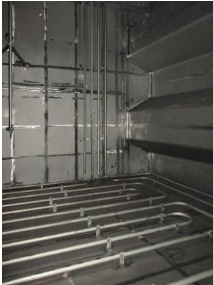
Slika 4. Unutrašnjost spremnika od dupleks čelika na tankeru za prijevoz kemikalija [10]
