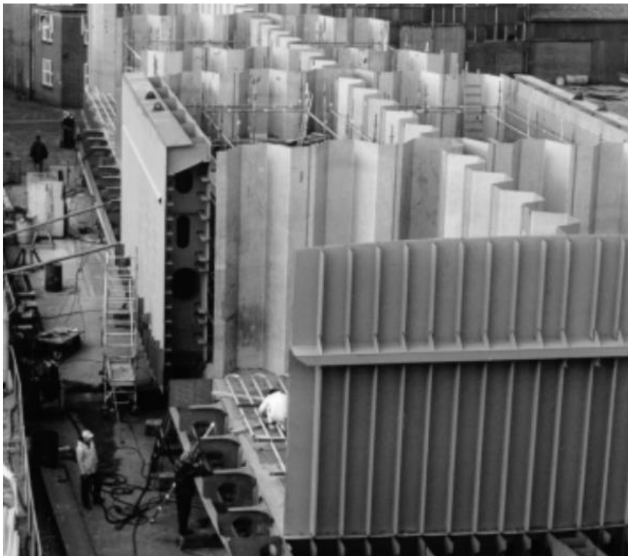
Slika 5. Prikaz rasporeda spremnika za kemikalije na tankeru tijekom proizvodnje[10]
