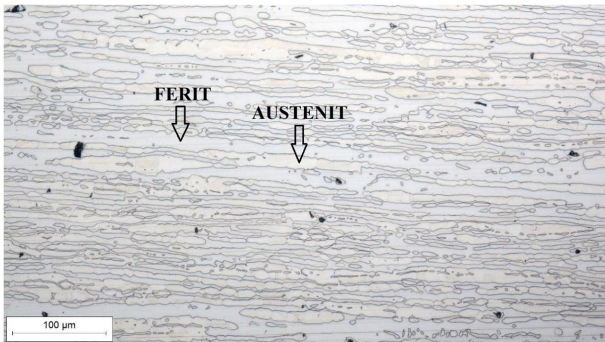
Slika 36. Mikrostruktura osnovnog materijala uz povećanje 200x
