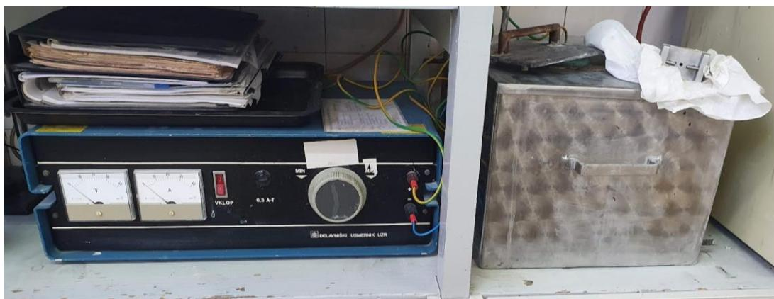
**Slika 26. Oprema za elektrokemijsko nagrizanje uzorka**
