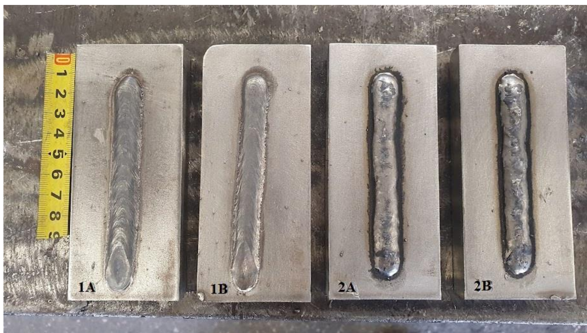
Slika 23. Navareni uzorci nakon čišćenja
