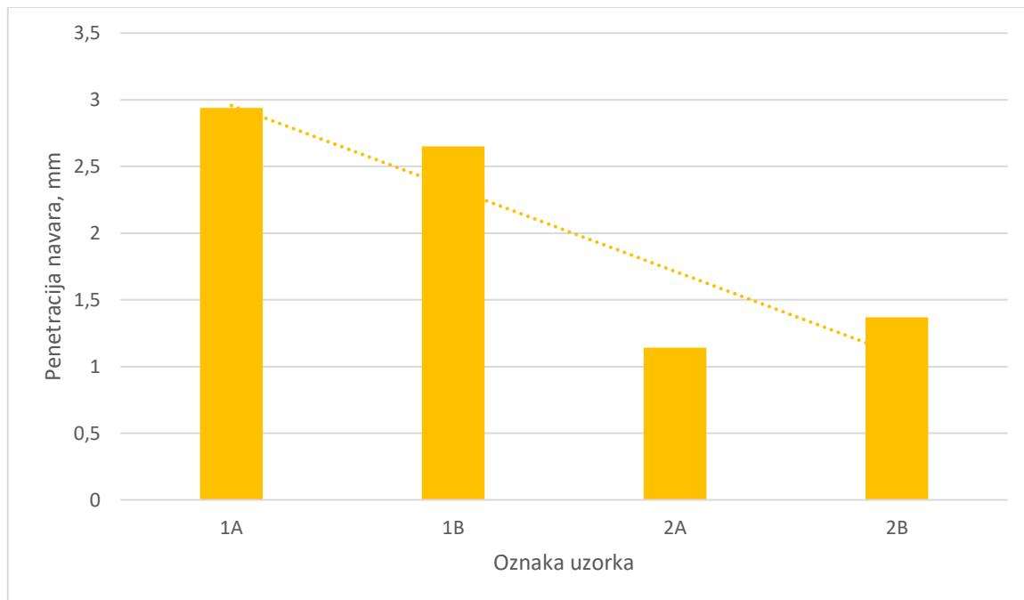
**Slika 34. Grafički prikaz promjene penetracije navara po uzorcima**
