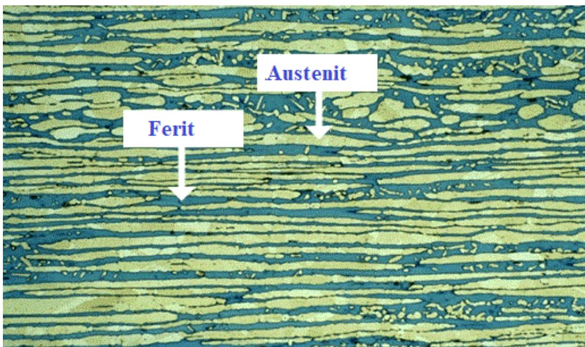
Slika 1. Dvofazna mikrostruktura dupleks nehrđajućeg čelika [4]
