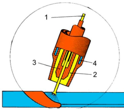
Slika 16. Shema procesa taljenja kod MIG/MAG postupka zavarivanja [17]
