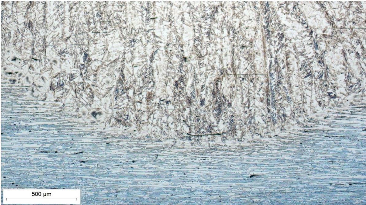
Slika 41. Mikrostruktura korijena navara uzorka 1A uz povećanje 50x
