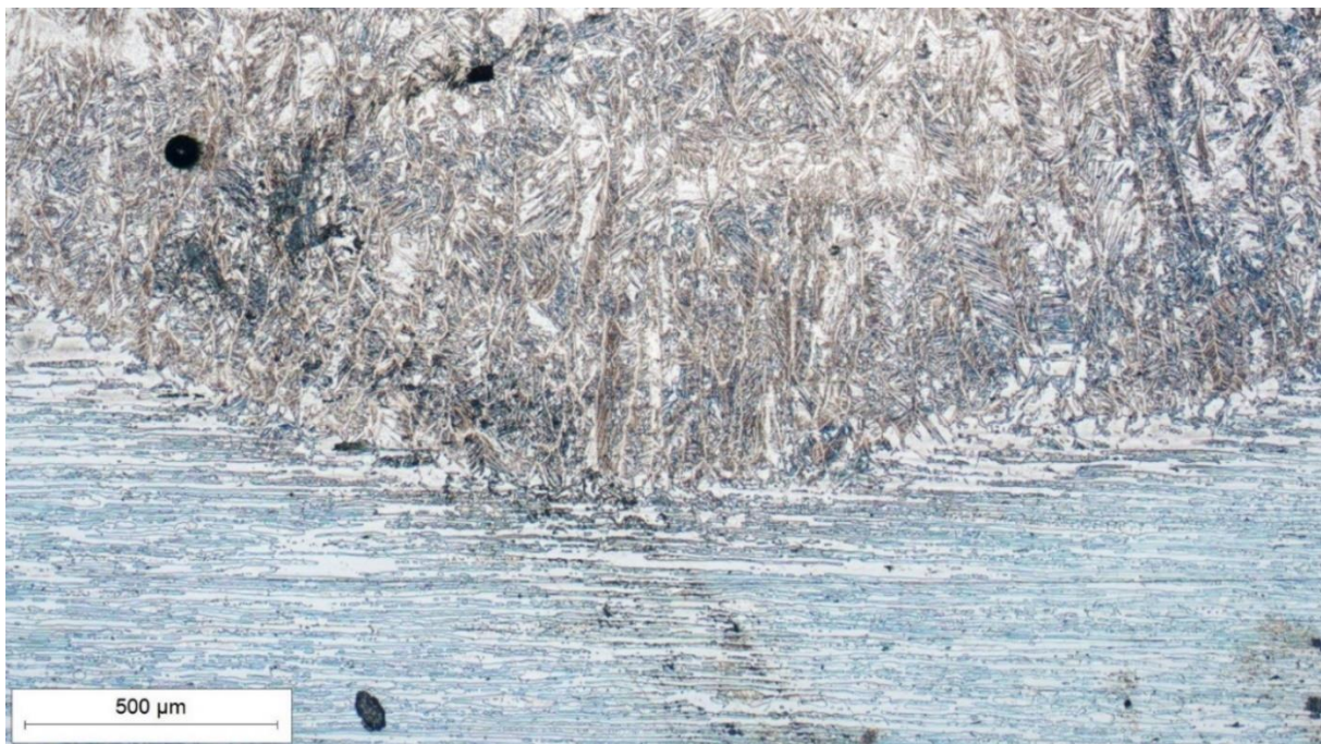
Slika 44. Mikrostruktura korijena navara uzorka 2B uz povećanje 50x
