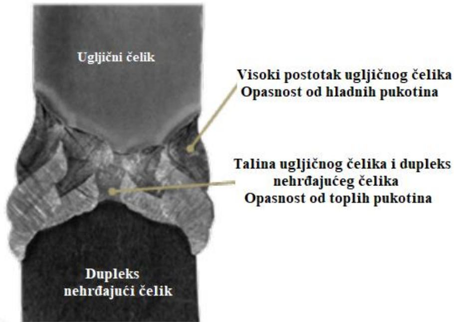
**Slika 15. Zavareni spoj dupleks čelika i ugljičnog čelika [5]**
