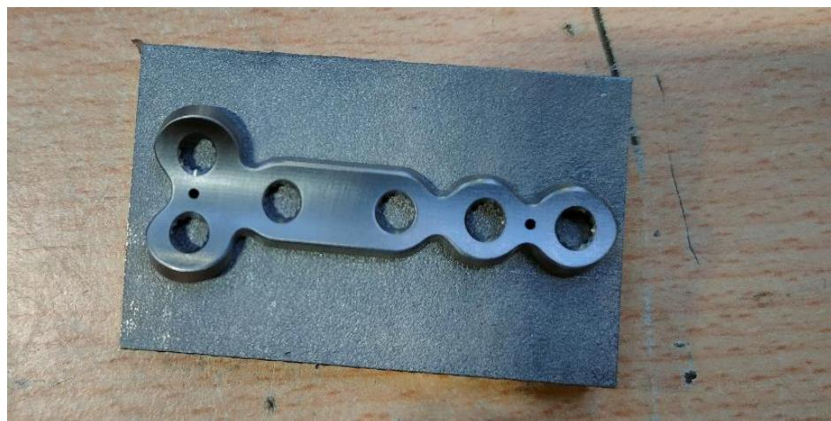
Slika 35. Usporedba izgleda sirovca i izratka pločice
