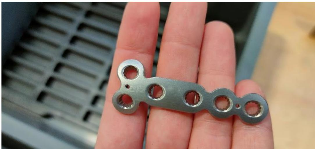
Slika 34. Izgled pločice nakon strojne obrade
