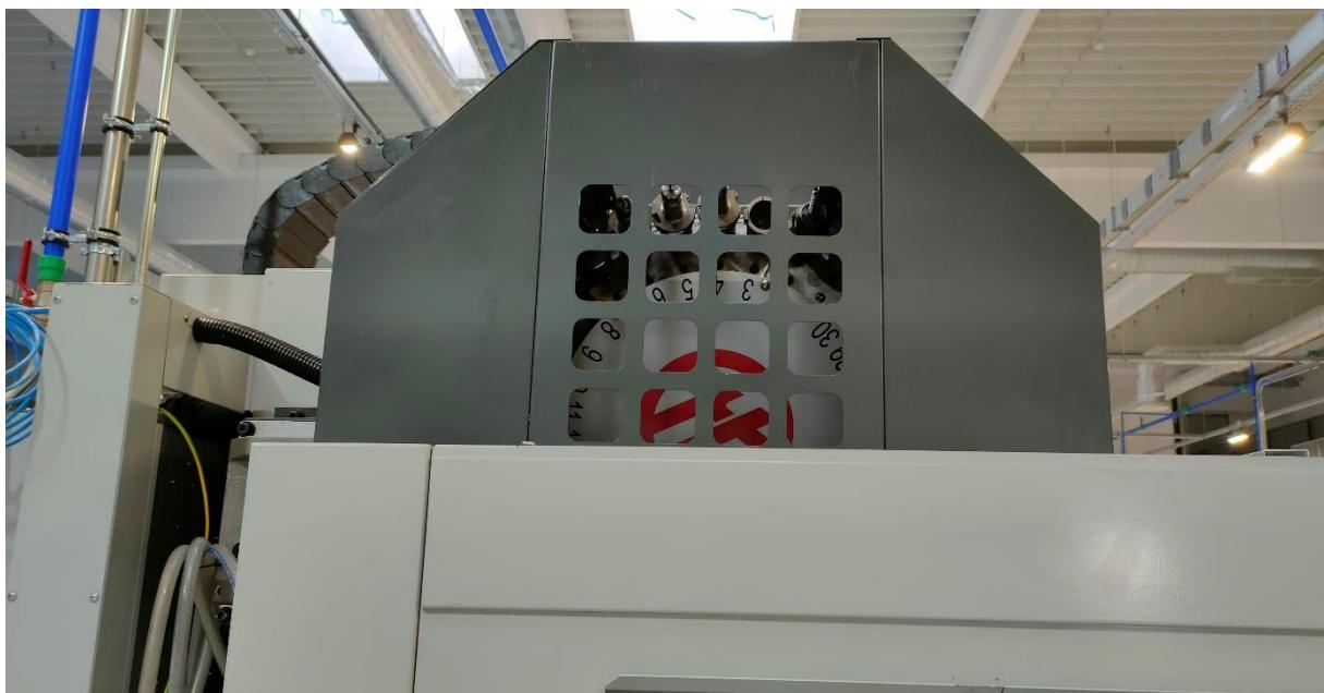
**Slika 18. HAAS VF-2SSYT spremište alata**
