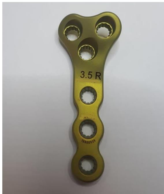
Slika 42. Konačan izgled pločice nakon završne obrade
