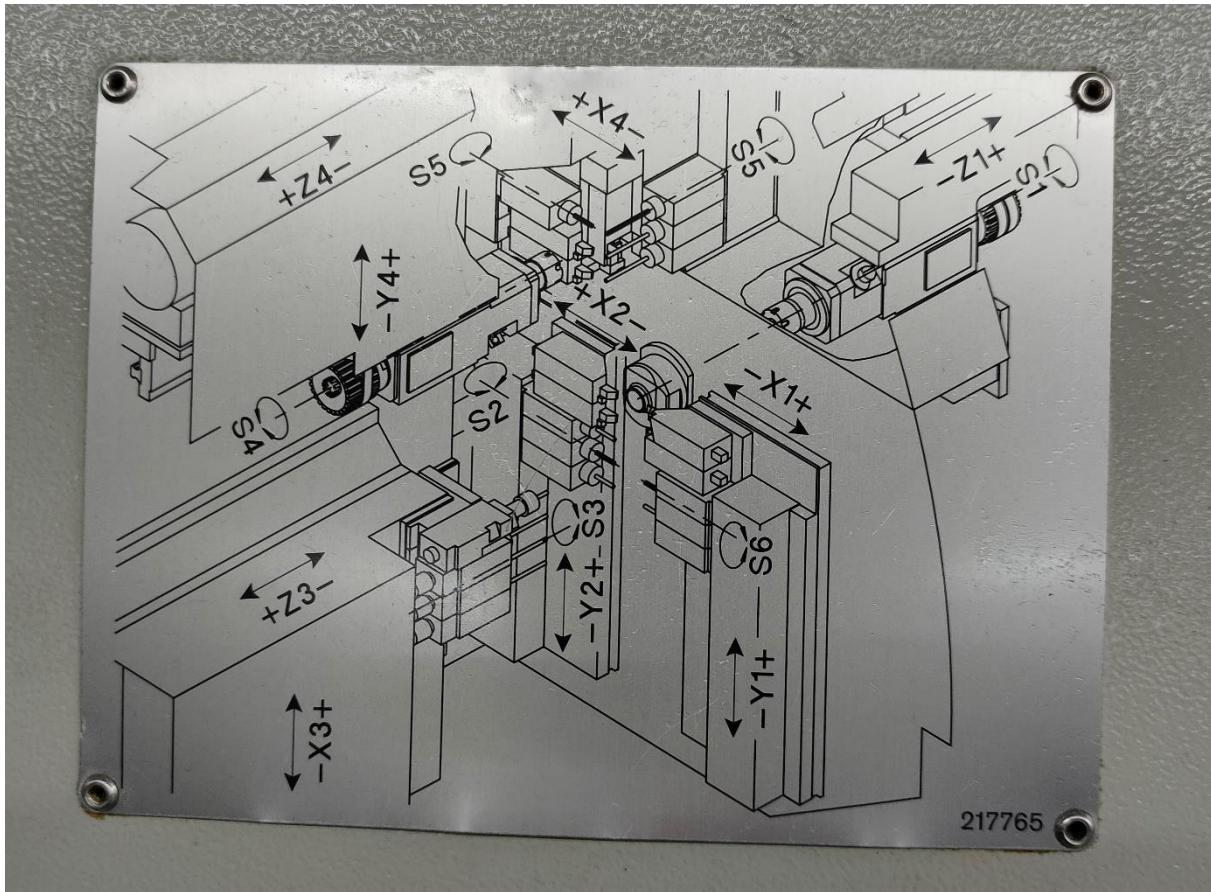
**Slika 19. Numeričke osi obradnog centra Tornos EvoDECO 16/10**
