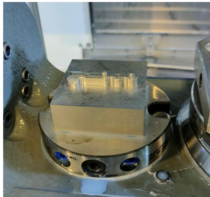
Slika 29. Specijalna stezna naprava za drugo stezanje
