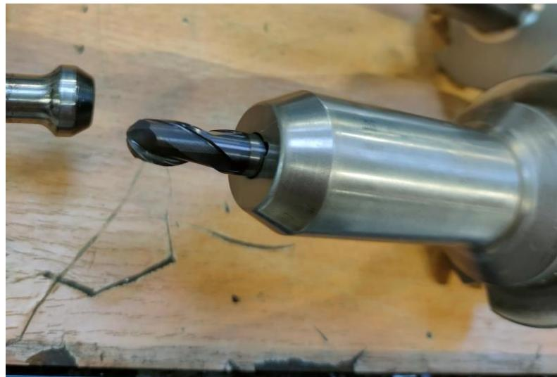
**Slika 32. Kuglasto glodalo Ø10**
