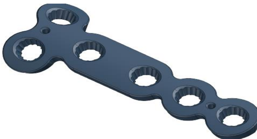
Slika 37. Mesh model skenirane pločice
