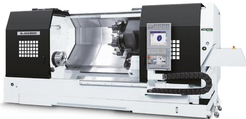
**Slika 4. Tokarski obradni centar DMG MORI SL 403 [10]**
