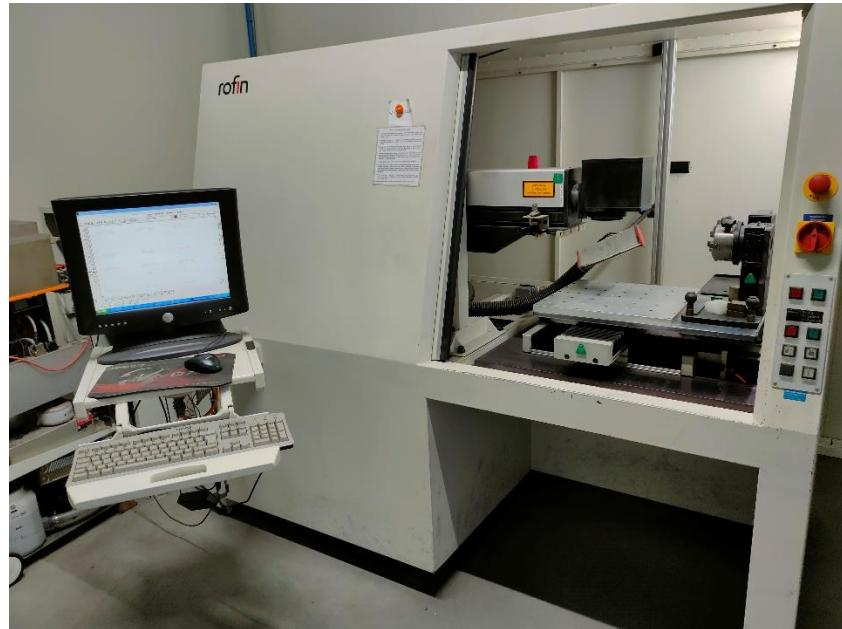
Slika 41. Uređaj za lasersko označavanje pločice
