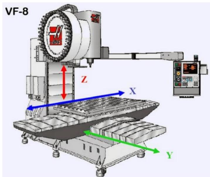
**Slika 3. Vertikalni glodači obradni centar s pripadajućim osima [9]**
