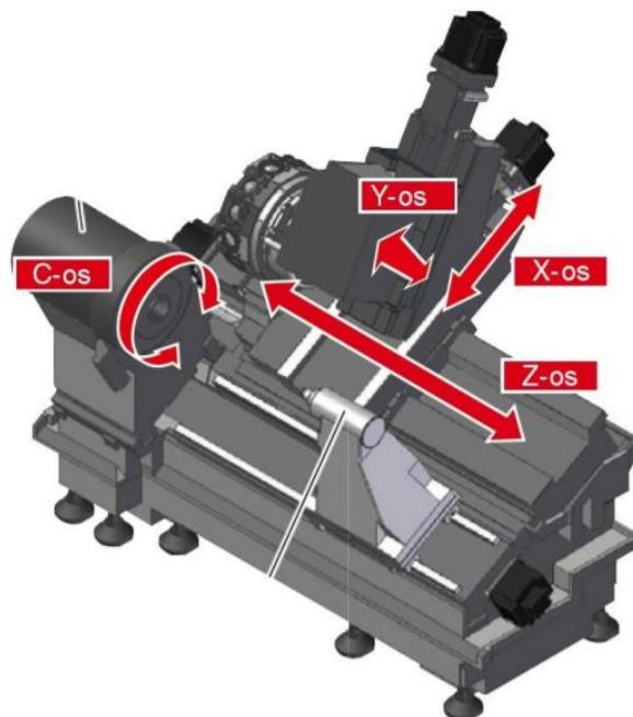
**Slika 2. Horizontalni tokarski obradni centar s pripadajućim osima [8]**
