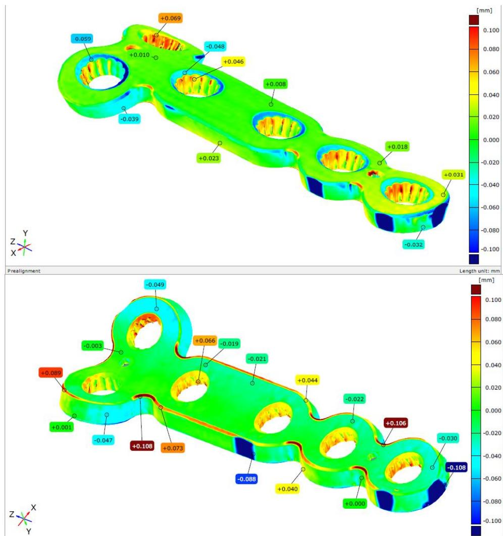
Slika 39. Odstupanje Mesh-a pločice od CAD modela
