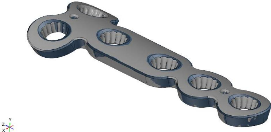
Slika 38. Preklapanje CAD modela i Mesh-a pločice
