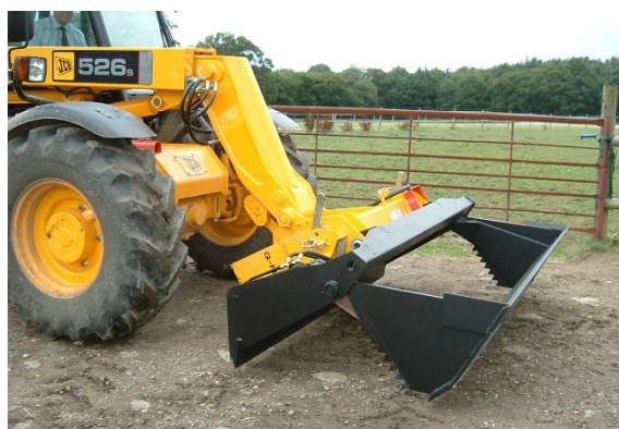
Slika 9. Otvoreni položaj višenamjenske utovarne lopate 4 u 1 [18]
