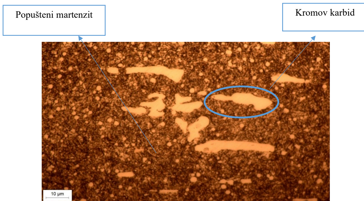
Slika 10. Mikrostruktura jezgre uzorka noža, povećanje 1000x
