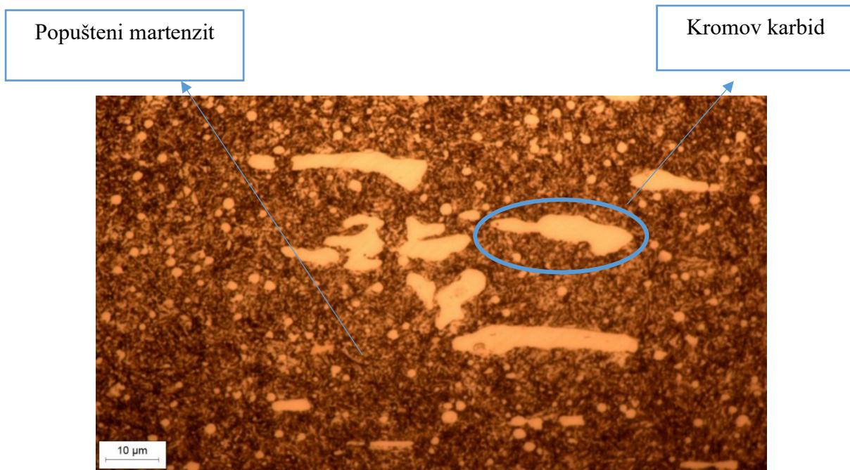
Slika 10. Mikrostruktura jezgre uzorka noža, povećanje 1000x
