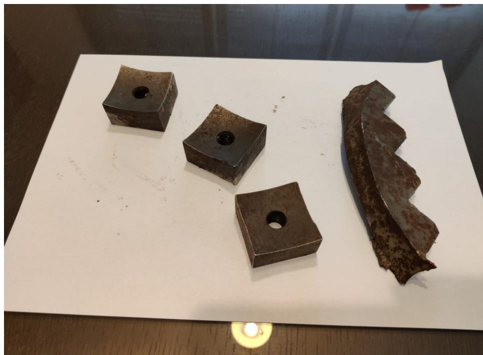
Slika 6. Primjer noževa za obradu plastike
