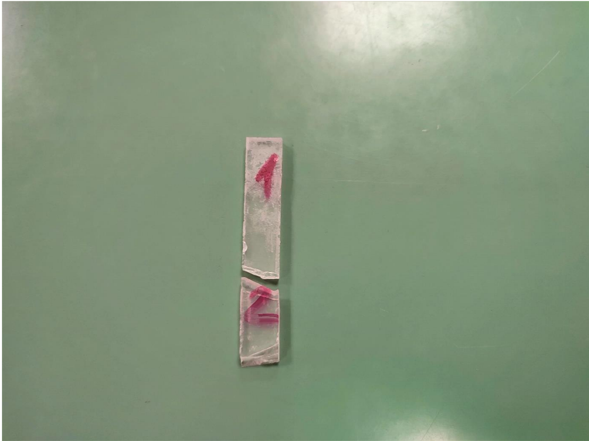
Slika 27. Slomljena epruveta nakon ispitivanja na Charpyjevom batu
