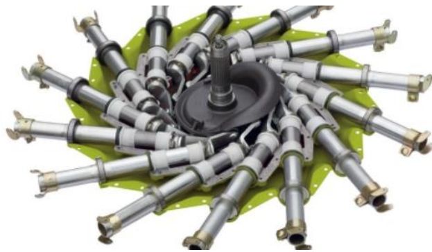
Slika 18. Otvoreno zvono sakupljača
