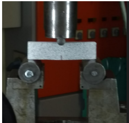
Slika 21 Ispitna konfiguracija: SENB epruveta
