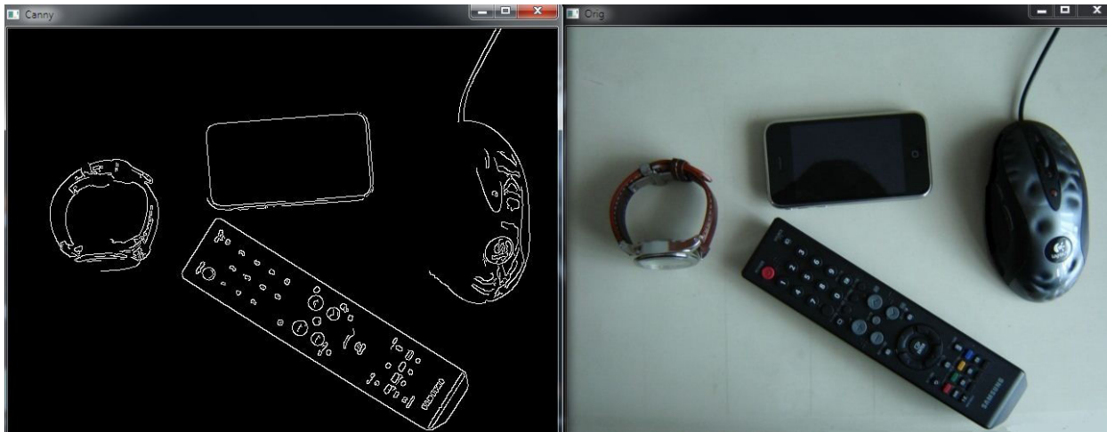
Slika 8: Primjena Canny algoritma, lijevo – Canny, desno – original
