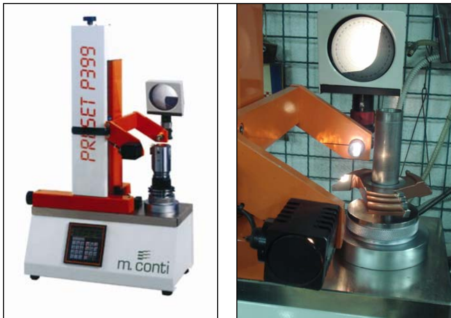
Slika 3.18 Preset uređaj za kontrolu i mjerenje alata
