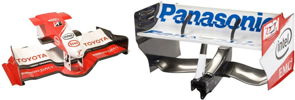
Slika 6. Prednje (lijevo) [9] i stražnje (desno) [10] krilo Formule 1
