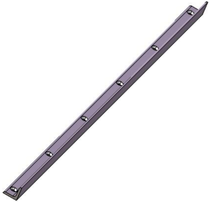
Slika 22. L-profil grede vibrododavača lijevi
