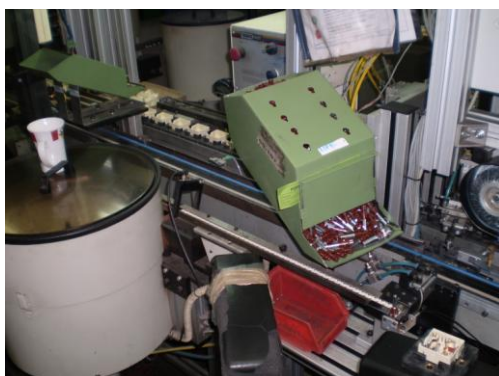
Slika 17. Vibrodođavač s gredom
